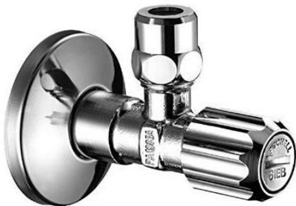
Roháčky – sedlový ventil, (ne kulový) s vnitřním sítkem
