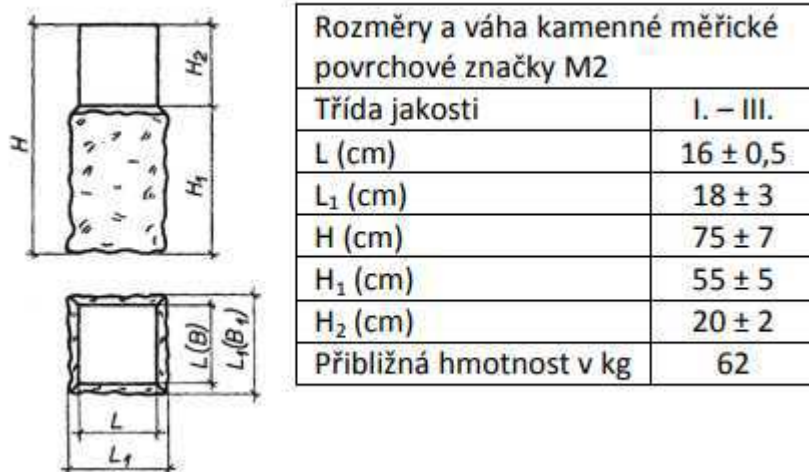
Obrázek 5 Rozměry povrchové kamenné značky M2
