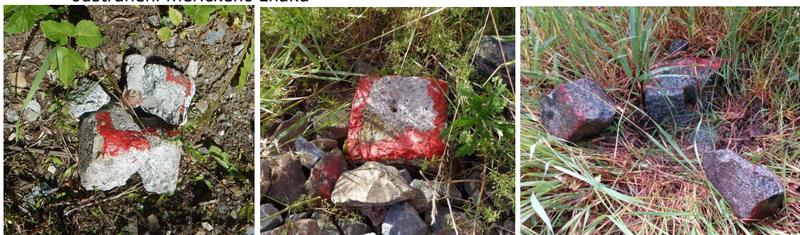
Obrázek 8 Ukázka zničených bodů sekáním trávy
