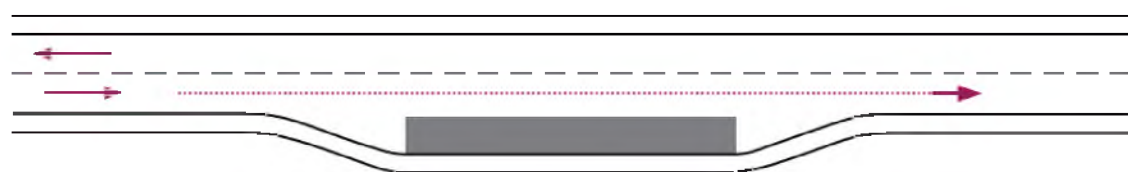
Obrázek 11 Autobusová (trolejbusová) zastávka mimo jízdni pruh (bez fyzického oddělení - zálivová zastávka) - Typ II
