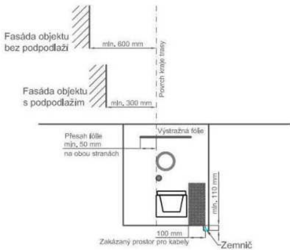
Obrázek 4 - Společná pravidla pro uložení kabelů
