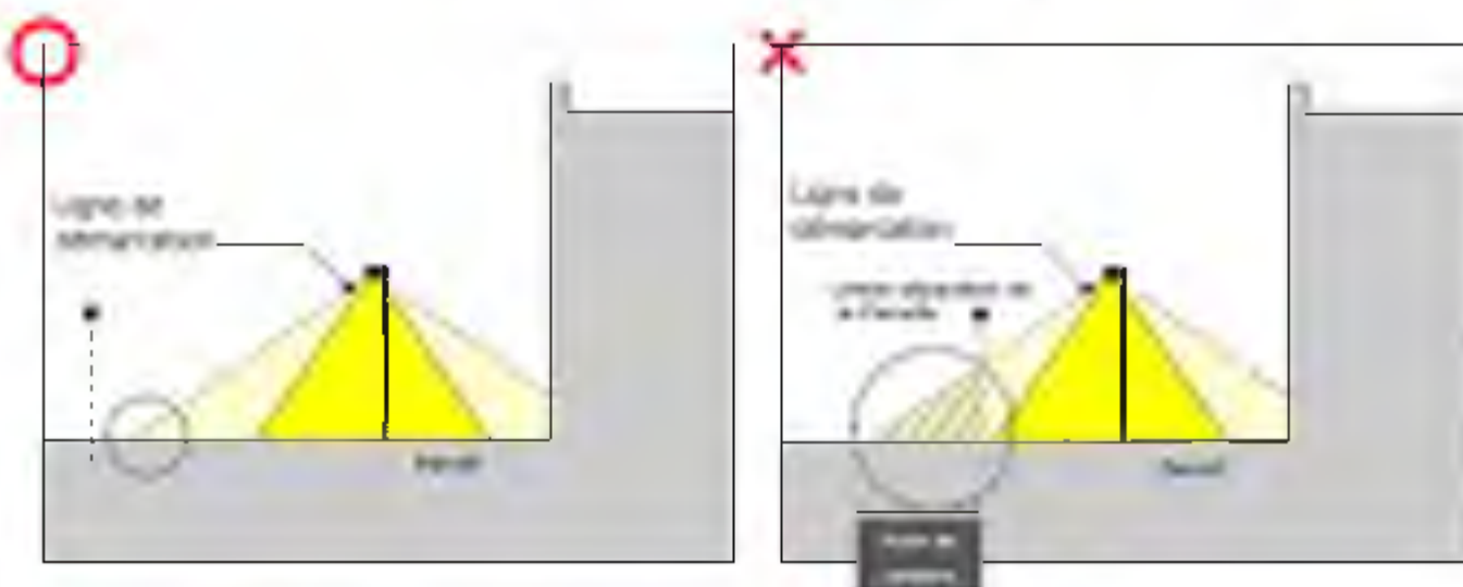
Figure 10 : Réduction de la lumière directe qui dépasse la limite séparative de la Parcelle (éclairage d'aménagement extérieur)
