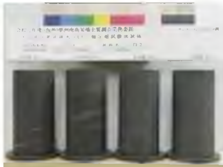
室内土質試験 土の非圧密非排水(UU)三軸圧縮試験供試体 No. 1: T1-2 GL-15.50~16.40m
