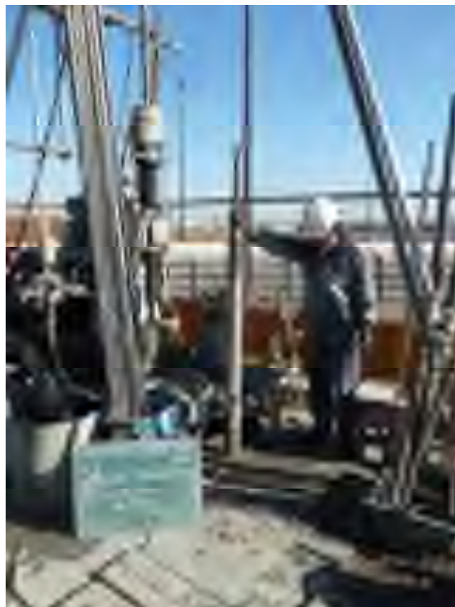
No. 3 乱れの少ない試料採取 (トリプルサンプリング)
