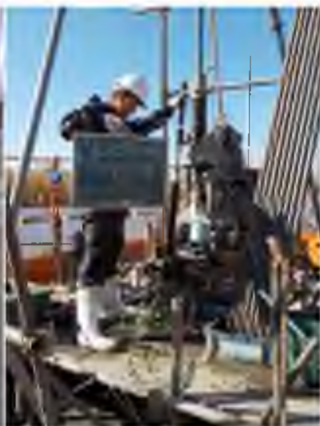
No. 1 孔内水平載荷試験 ゾンデ挿入状況 GL-31.50m
