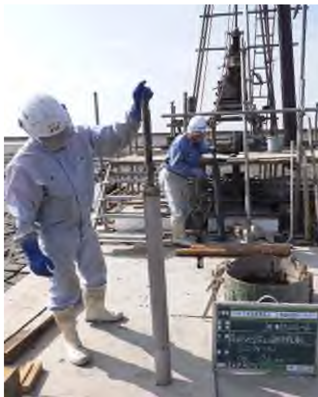
乱れの少ない試料採取（シンウォールサンプリング） (23.00～23.52m)
