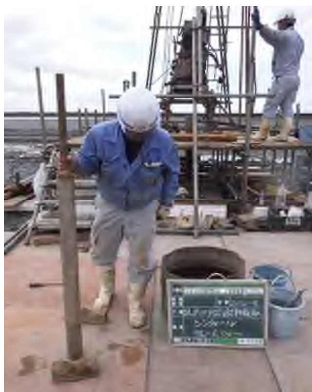
乱れの少ない試料採取（シンウォールサンプリング） (5.00～5.89m)
