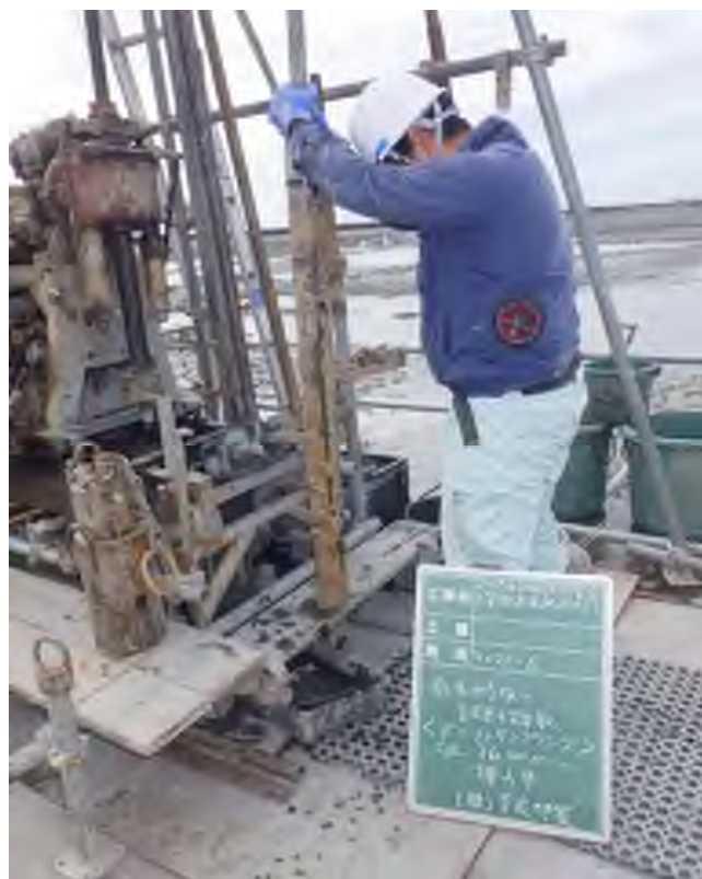
乱れの少ない試料採取（デニソン） (26.00～26.50m)
