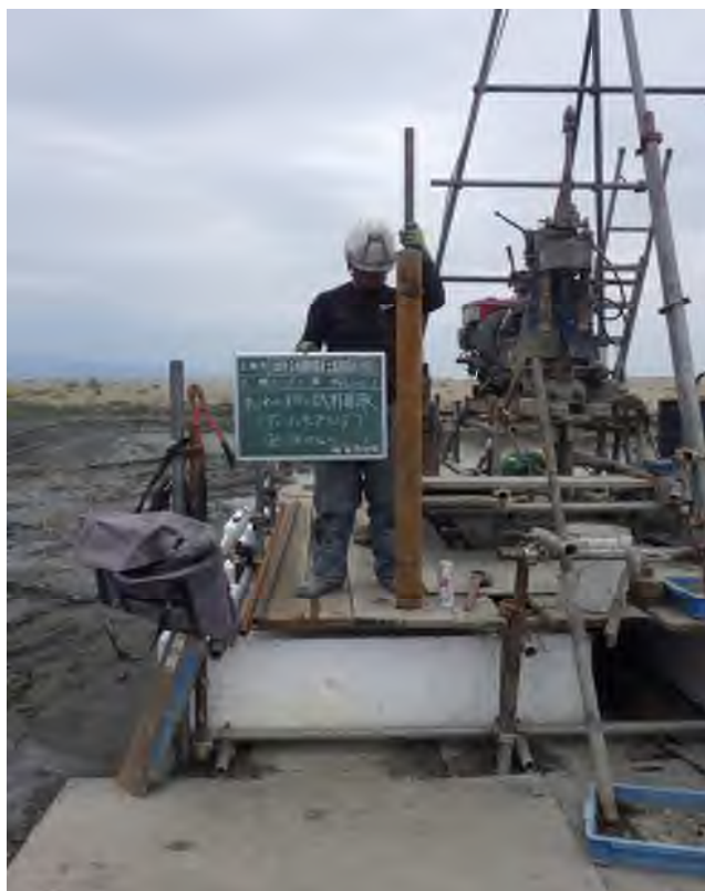
乱れの少ない試料採取（デニソンサンプリング） (58.00～58.45m)
