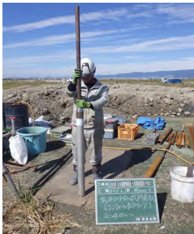
乱れの少ない試料採取（シンウォールサンプリング） (22.00～22.90m)
