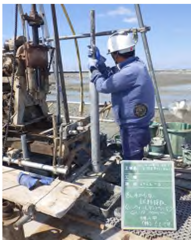
乱れの少ない試料採取（シンウォールサンプリング） (11.00～11.80m)
