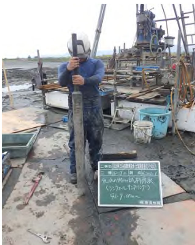
乱れの少ない試料採取（シンウォールサンプリング） (9.00~9.90m)
