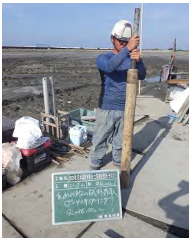
乱れの少ない試料採取（デニソンサンプリング） (36.00～36.90m)
