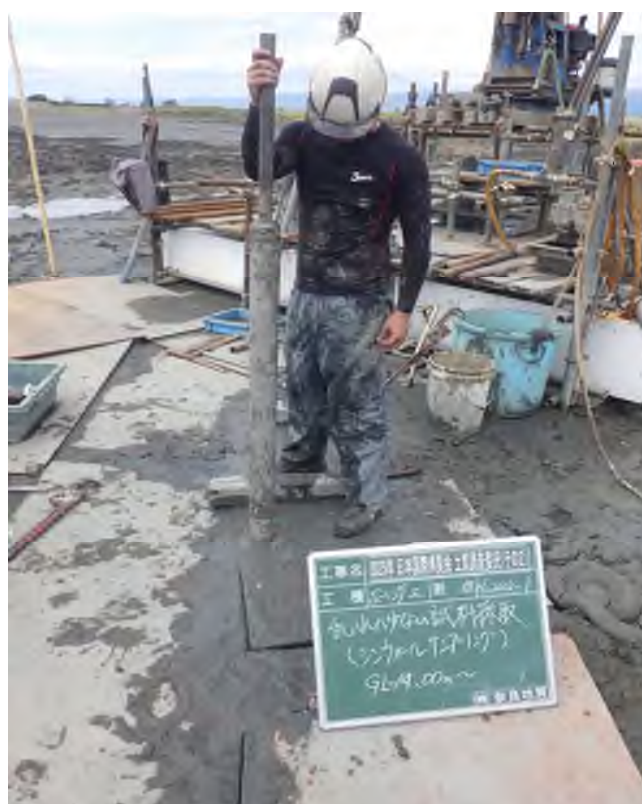
乱れの少ない試料採取（シンウォールサンプリング） (13.00～13.90m)
