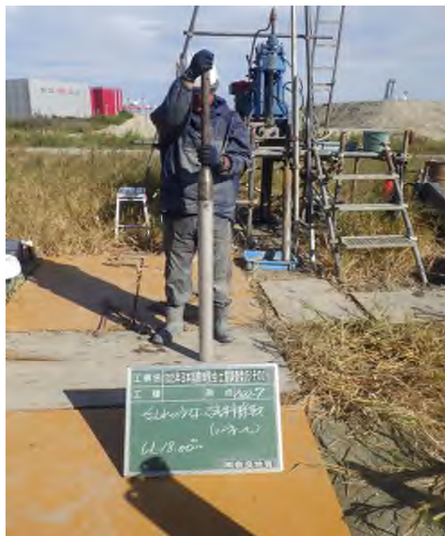
乱れの少ない試料採取（シンウォールサンプリング） (17.00～17.60m)
