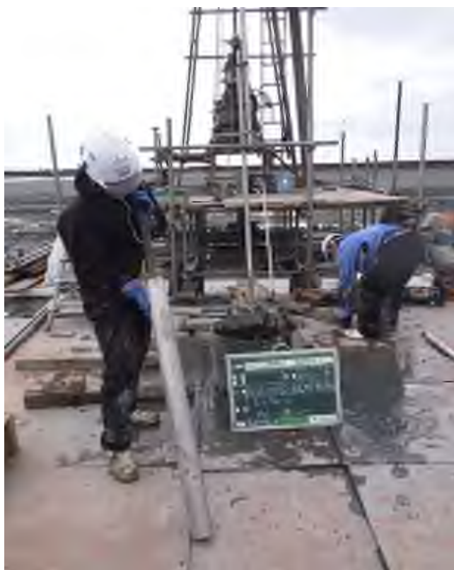
乱れの少ない試料採取（シンウォールサンプリング） (17.00～17.72m)
