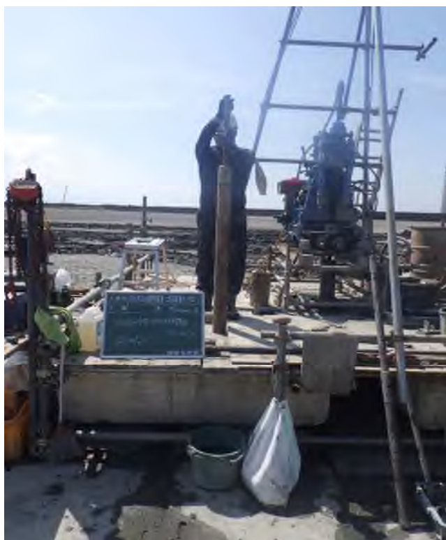
乱れの少ない試料採取（デニソンサンプリング） (45.00～45.45m)
