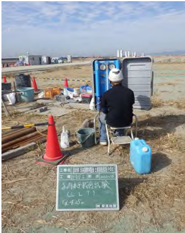
(3.95~4.55m) 孔内水平載荷試験
