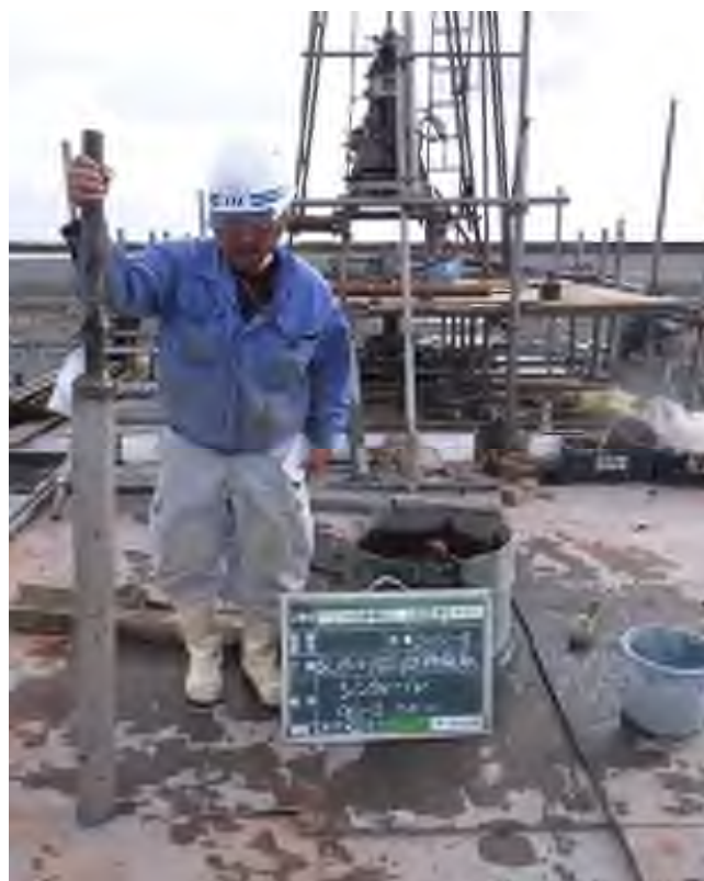
乱れの少ない試料採取（シンウォールサンプリング） (11.00～11.77m) (12.00～12.77m)
