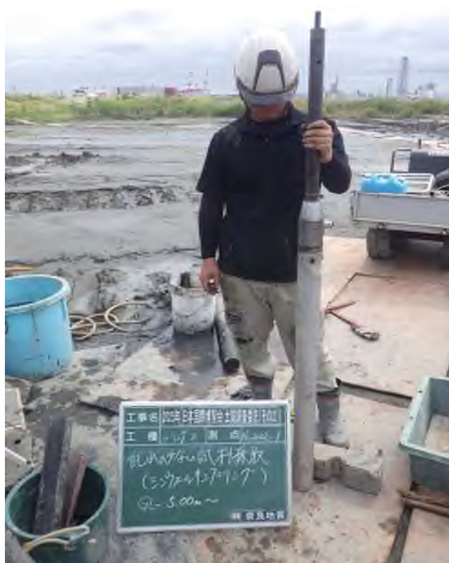
乱れの少ない試料採取（シンウォールサンプリング） (5.00～5.90m)
