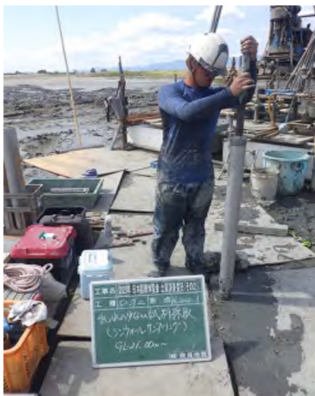
乱れの少ない試料採取（シンワールサンプリング） (21.00～21.90m)
