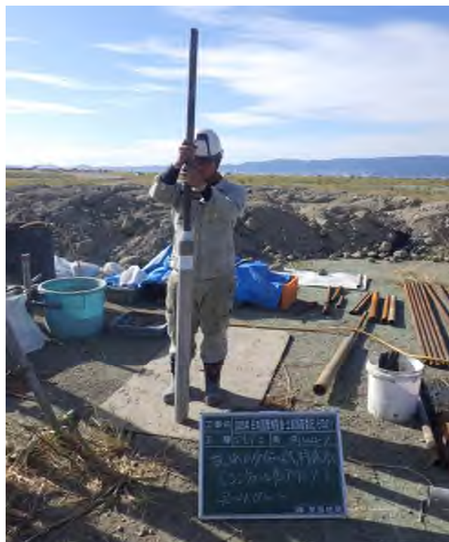
乱れの少ない試料採取（シンウォールサンプリング） (20.00～20.90m)
