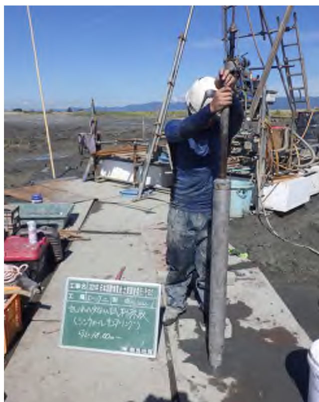
乱れの少ない試料採取（シンウォールサンプリング） (17.00～17.90m)
