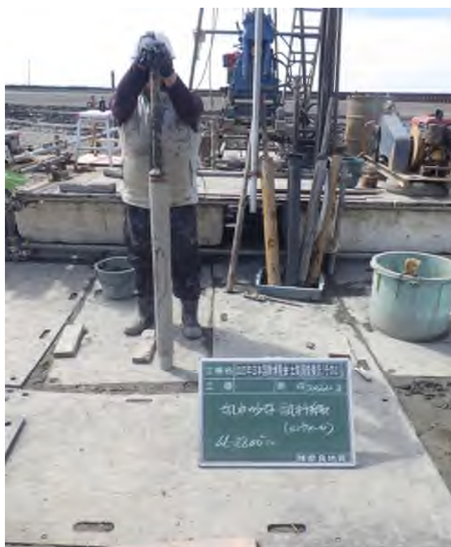
乱れの少ない試料採取（シンウォールサンプリング） (22.00～22.80m)
