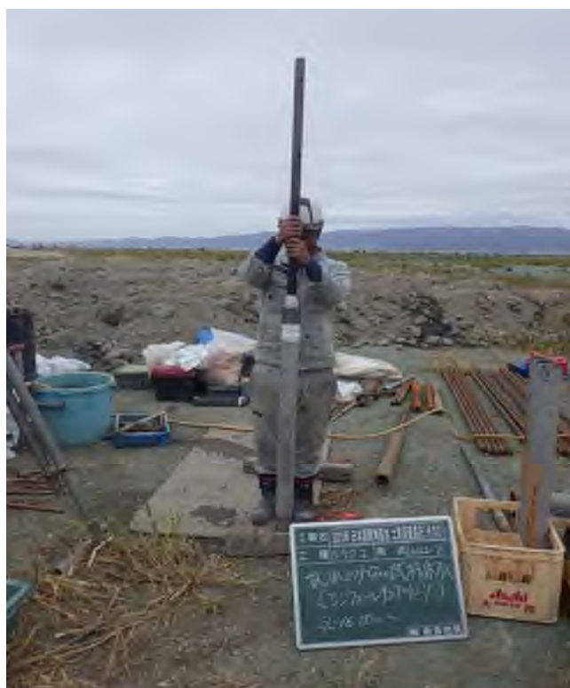
乱れの少ない試料採取（シンウォールサンプリング） (16.00～16.90m)
