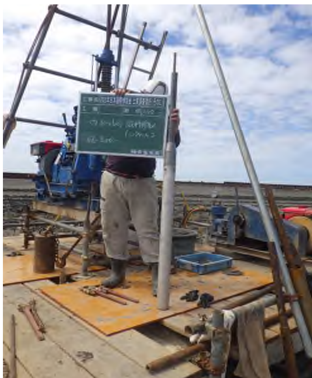
乱れの少ない試料採取（シンウォールサンプリング） (3.00～3.80m)
