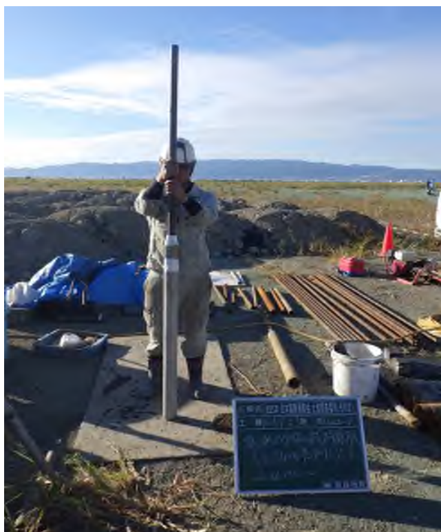
乱れの少ない試料採取（シンウォールサンプリング） (22.00～22.90m)
