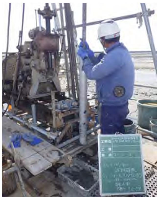
乱れの少ない試料採取（シンウォールサンプリング） (15.00~15.90m)
