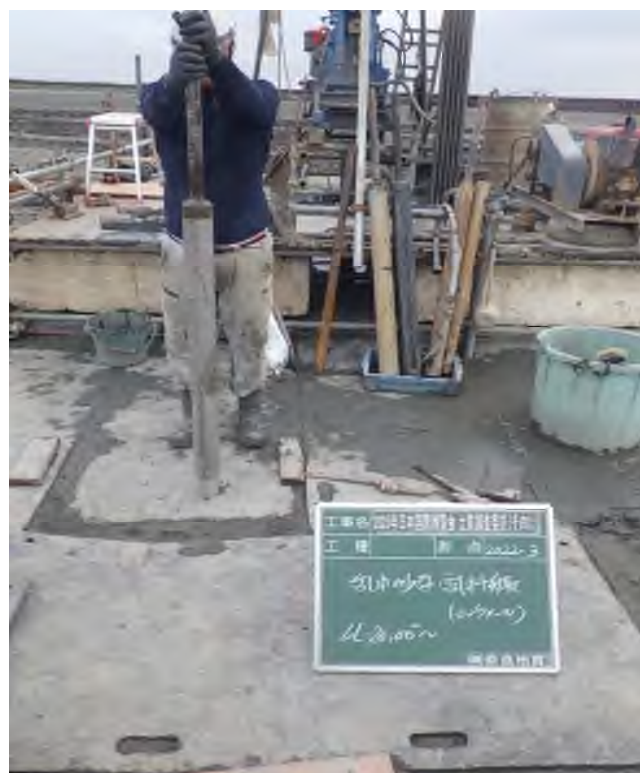
乱れの少ない試料採取（シンウォールサンプリング） (19.00～19.80m)
