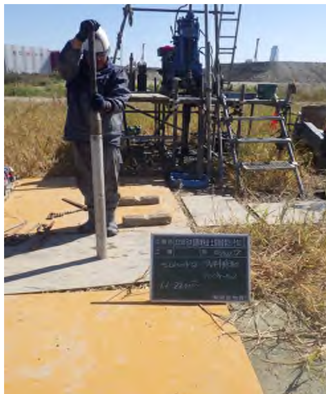
乱れの少ない試料採取（シンウォールサンプリング） (21.00～21.60m)
