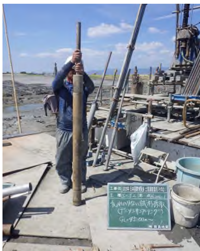
乱れの少ない試料採取（デニソンサンプリング） (42.00～42.50m)
