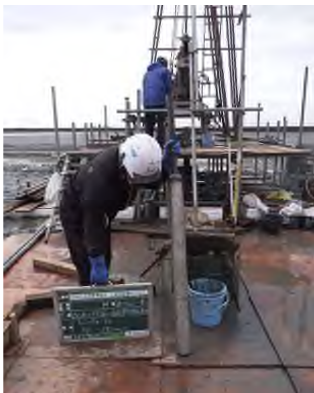
乱れの少ない試料採取（シンウォールサンプリング） (15.00～15.80m)
