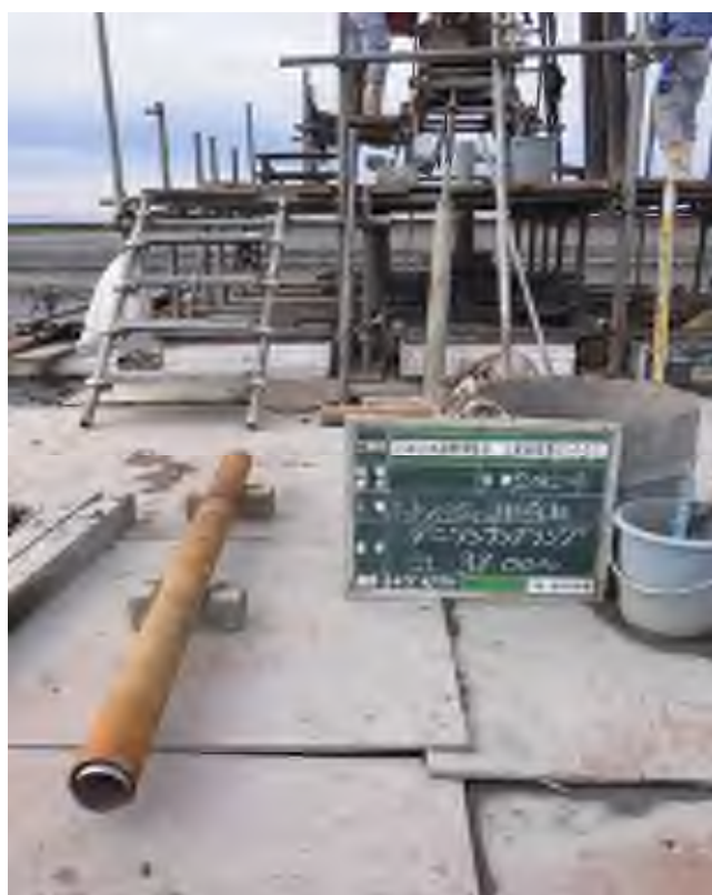
乱れの少ない試料採取（デニソンサンプリング） (38.00～38.40m)
