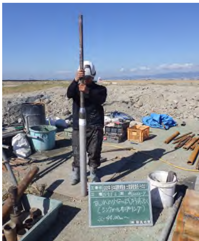
乱れの少ない試料採取（シンウォールサンプリング） (44.00～44.70m)
