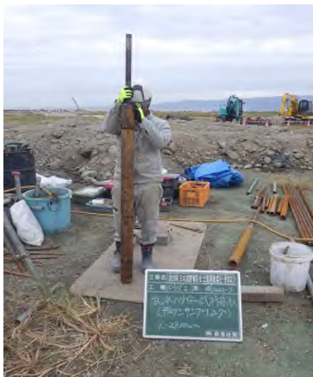
乱れの少ない試料採取（デニソンサンプリング） (29.00～29.90m)
