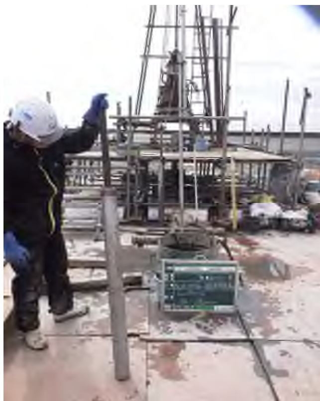
乱れの少ない試料採取（シンウォールサンプリング） (17.00～17.72m)
