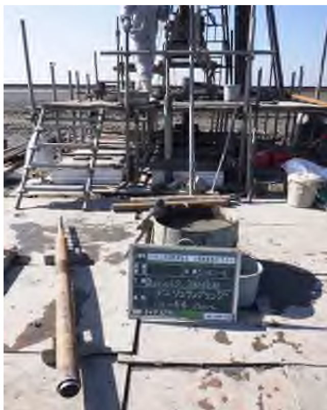
乱れの少ない試料採取（デニソンサンプリング） (44.00～44.55m) (57.00～57.75m)
