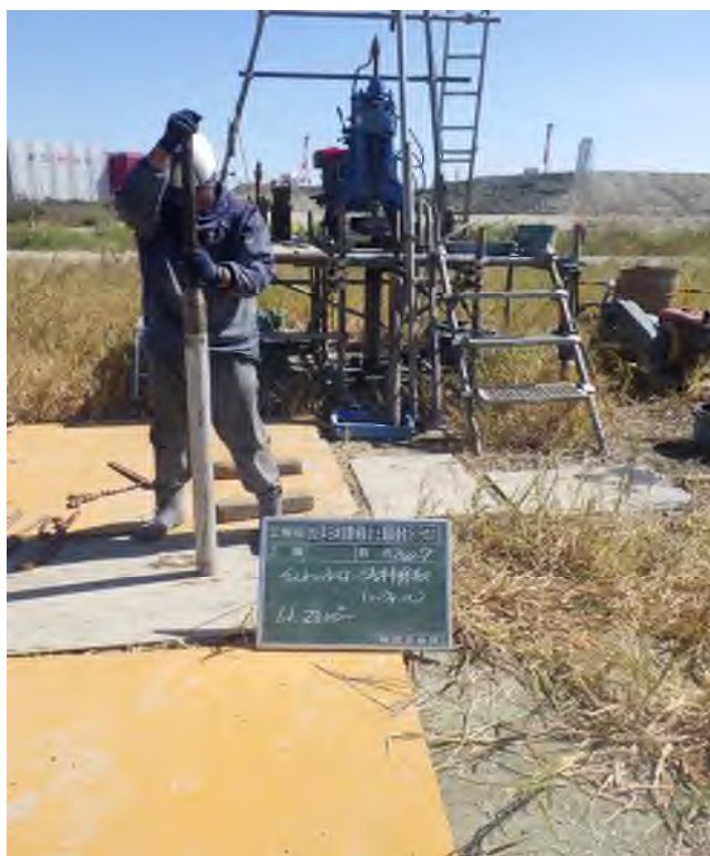
乱れの少ない試料採取（シンウォールサンプリング） (23.00～23.55m)
