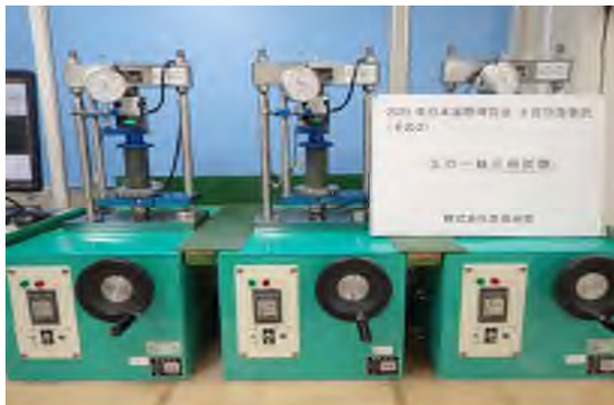
土の一軸圧縮試験 JIS A 1216
