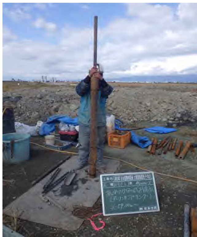
乱れの少ない試料採取（デニソンサンプリング） (50.00～50.65m)
