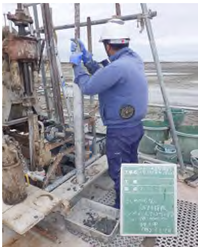
乱れの少ない試料採取（シンウォールサンプリング） (18.00～18.70m)
