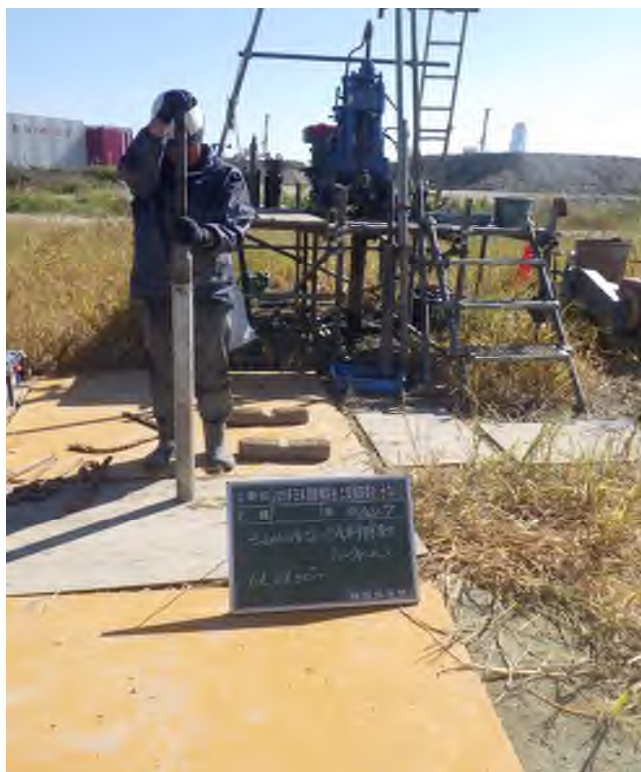
乱れの少ない試料採取（シンウォールサンプリング） (21.00～21.60m)
