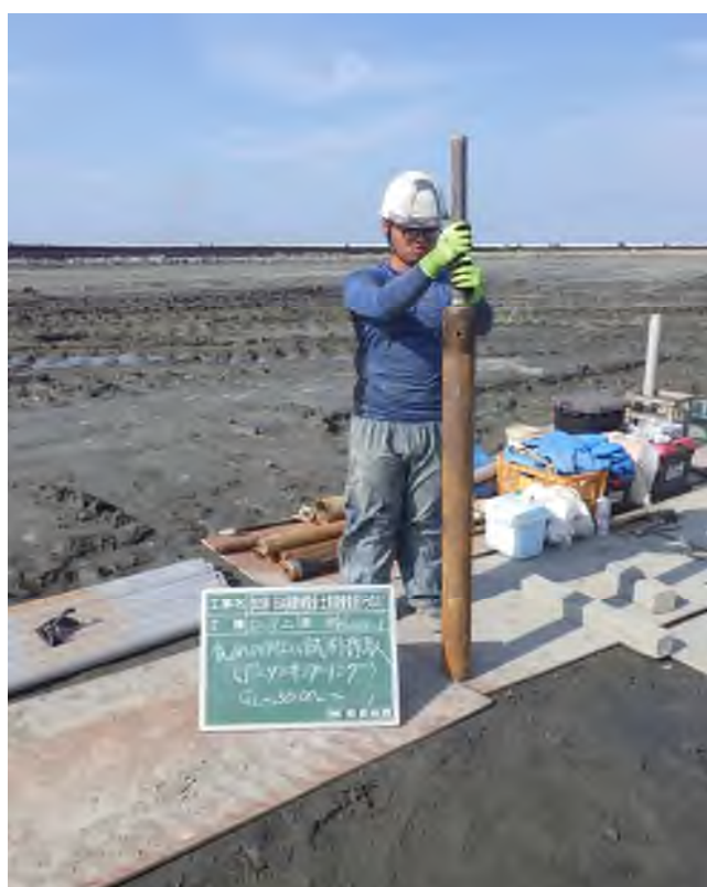
乱れの少ない試料採取（デニソンサンプリング） (30.00～30.80m)
