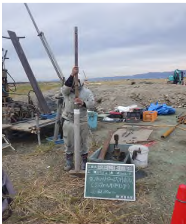
乱れの少ない試料採取 (シンウォールサンプリング) (32.00~32.80m)
