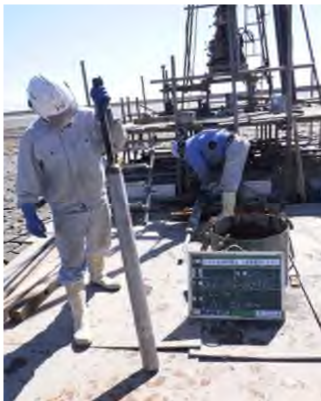
乱れの少ない試料採取（シンウォールサンプリング） (23.00～23.52m)
