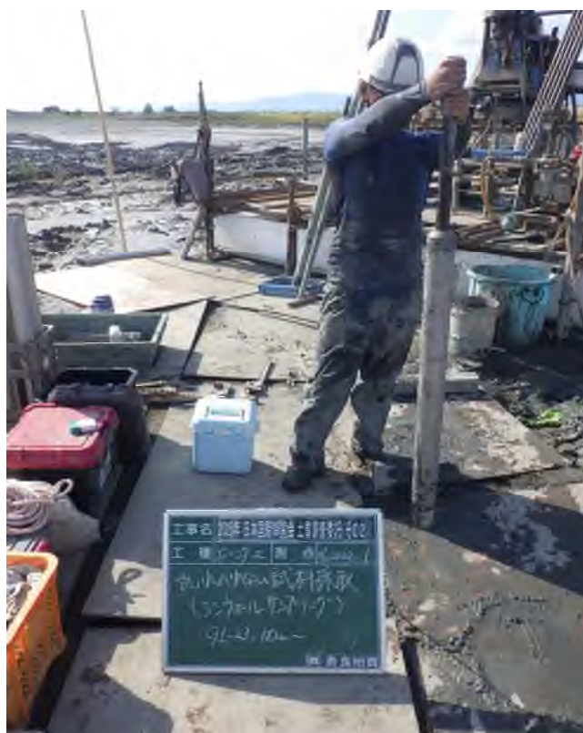
乱れの少ない試料採取（シンワールサンプリング） (23.00～23.90m)
