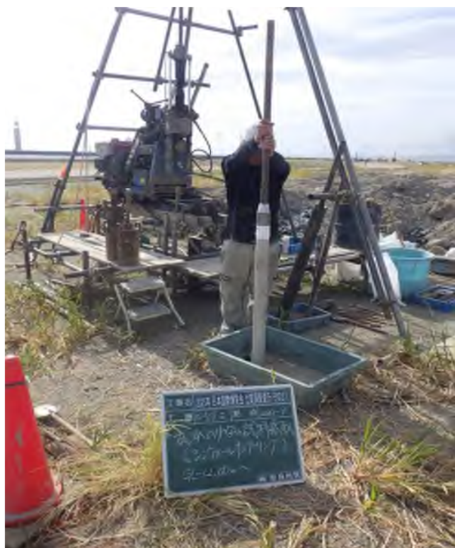
乱れの少ない試料採取（シンウォールサンプリング） (12.00～12.90m)
