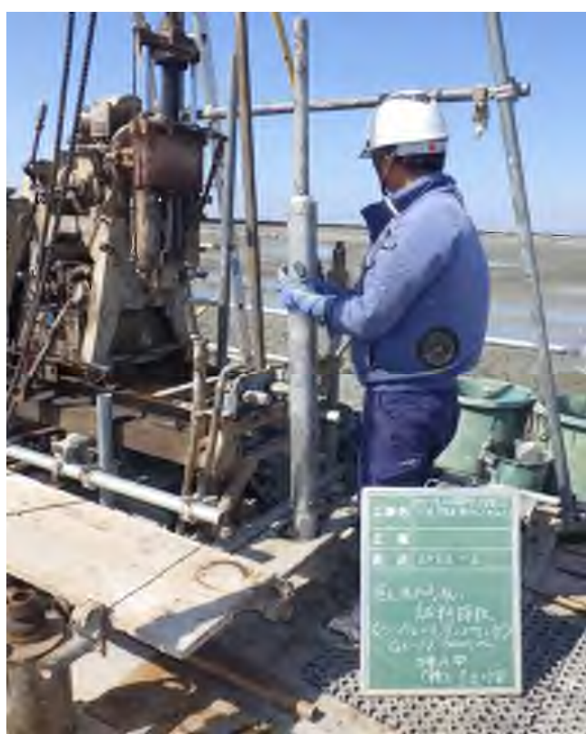
乱れの少ない試料採取（シンウォールサンプリング） (11.00～11.80m)
