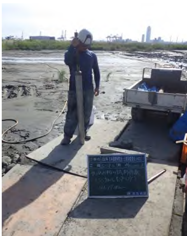
乱れの少ない試料採取（シンウォールサンプリング） (17.00～17.90m)
