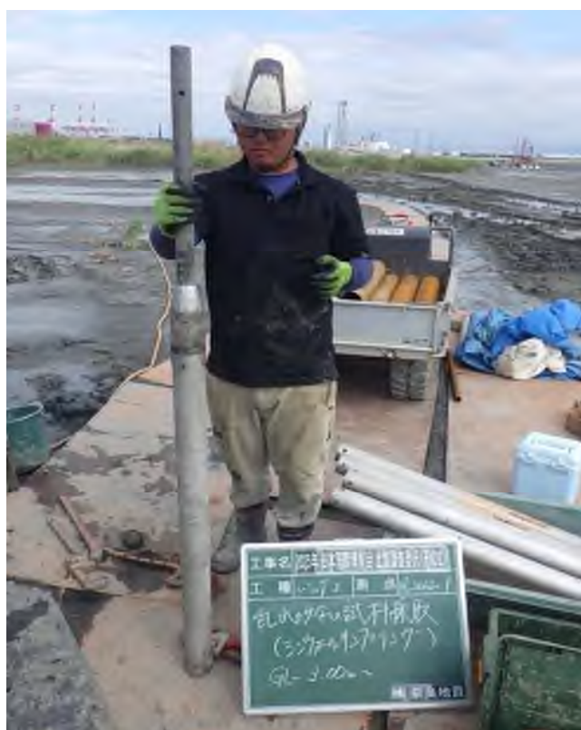
乱れの少ない試料採取（シンウォールサンプリング） (3.00～3.90m)
