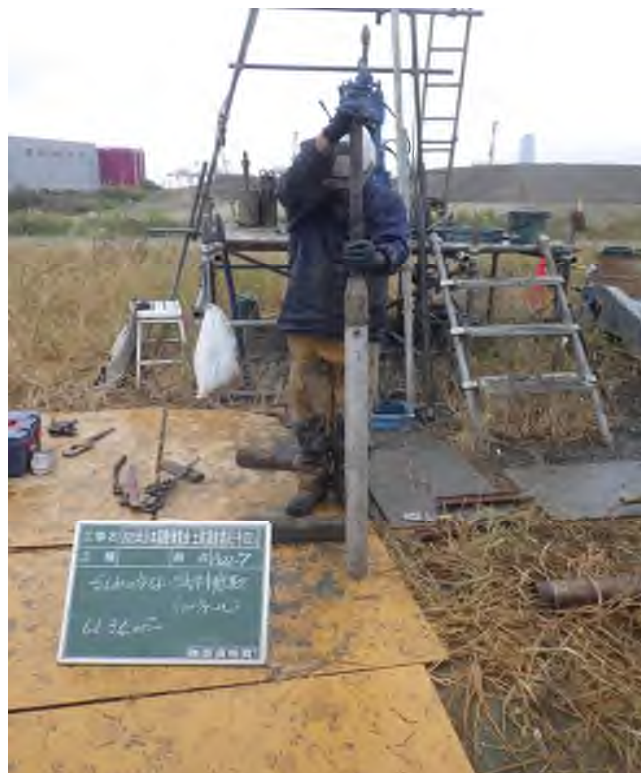
乱れの少ない試料採取（シンウォールサンプリング） (32.00～32.70m)
