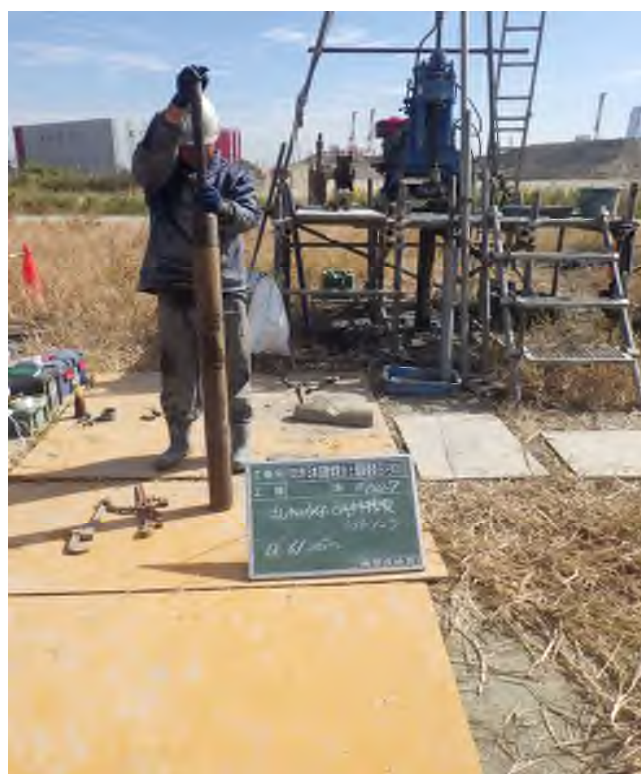
乱れの少ない試料採取（デニソンサンプリング） (50.00～50.55m)
