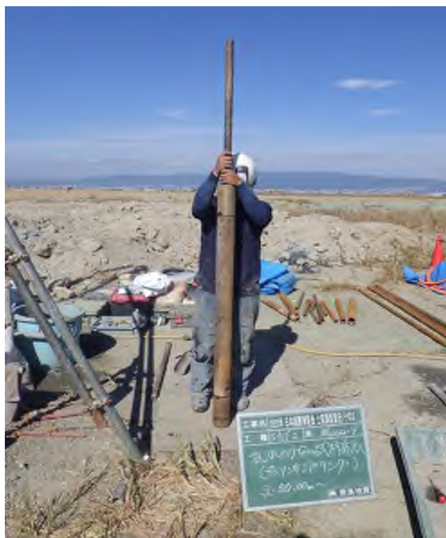
乱れの少ない試料採取（デニソンサンプリング） (50.00～50.65m)
