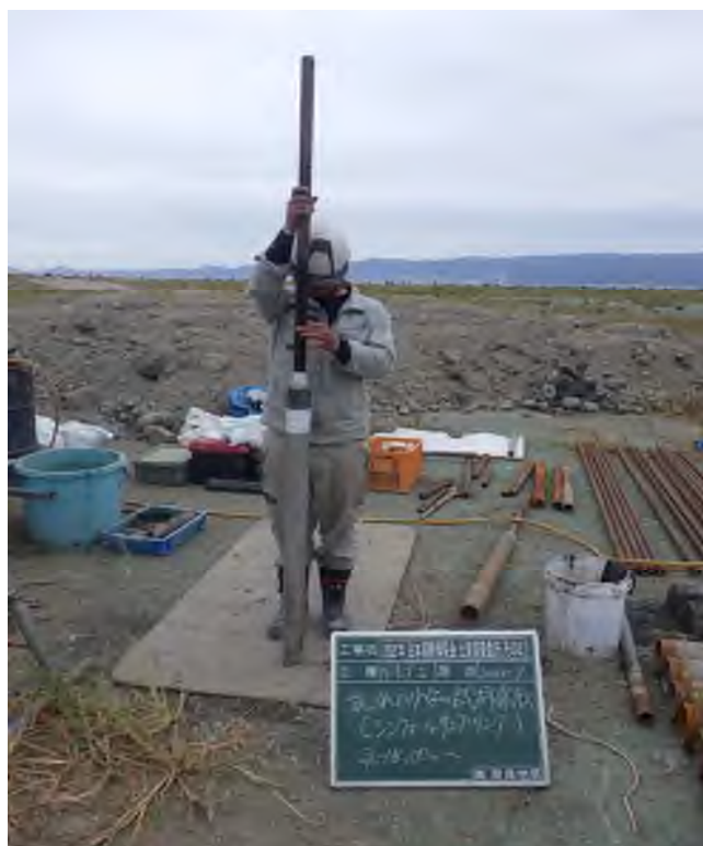
乱れの少ない試料採取（シンウォールサンプリング） (18.00～18.90m)
