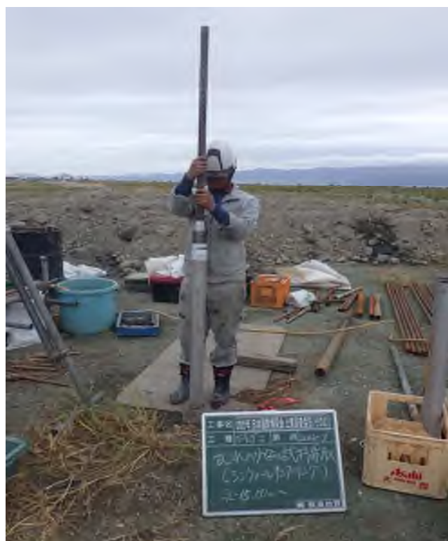
乱れの少ない試料採取（シンウォールサンプリング） (14.00～14.90m)
