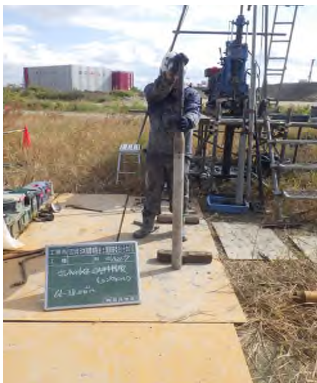
乱れの少ない試料採取（シンウォールサンプリング） (38.00～38.65m)
