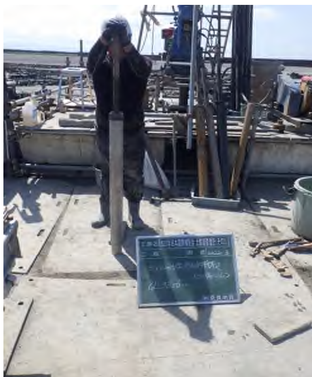
乱れの少ない試料採取（シンウォール） (33.00～33.40m)
