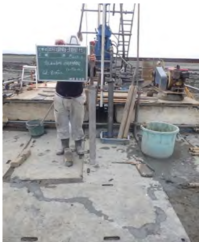
乱れの少ない試料採取（シンウォールサンプリング） (7.00～7.80m)
