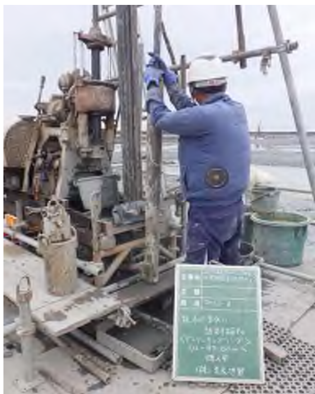
乱れの少ない試料採取（デニソンサンプリング） (47.00～47.45m) (57.00～57.75m)
