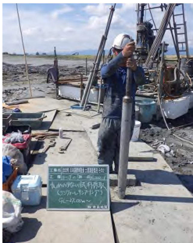
乱れの少ない試料採取（シンワールサンプリング） (23.00～23.90m)
