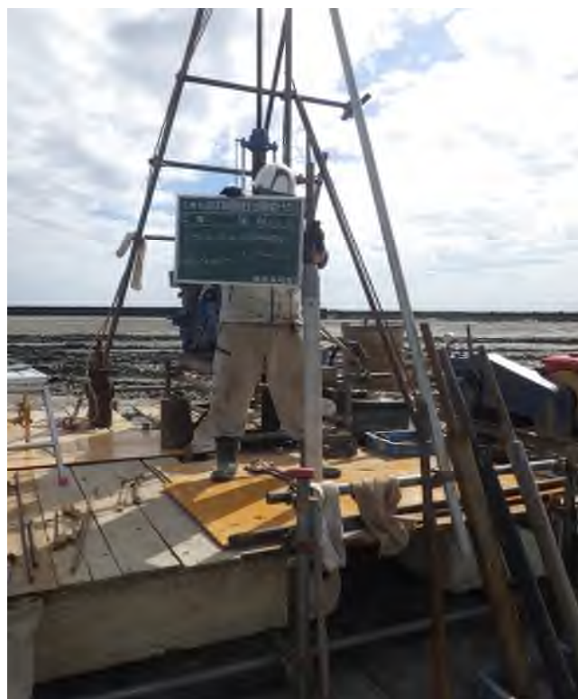
乱れの少ない試料採取（シンウォールサンプリング） (3.00～3.80m)
