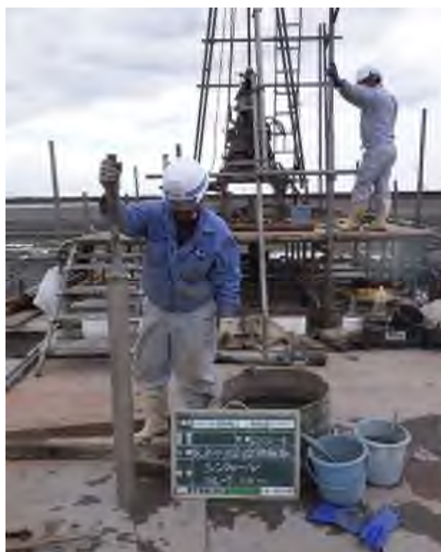
乱れの少ない試料採取（シンウォールサンプリング） (7.00～7.77m)
