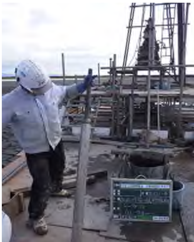
乱れの少ない試料採取（シンウォールサンプリング） (19.00～19.77m)
