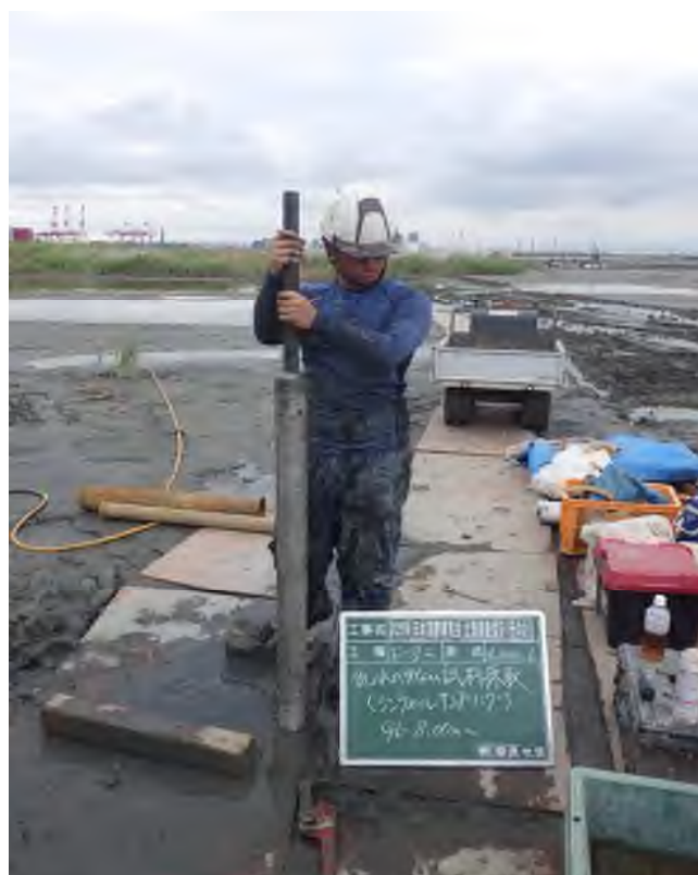
乱れの少ない試料採取（シンウォールサンプリング） (7.00~7.90m)
