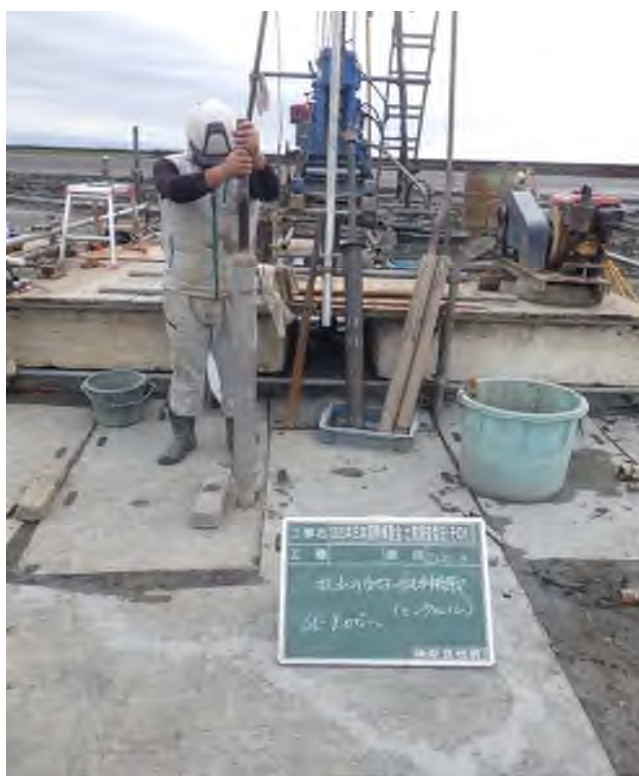
乱れの少ない試料採取（シンウォールサンプリング） (9.00～9.80m)
