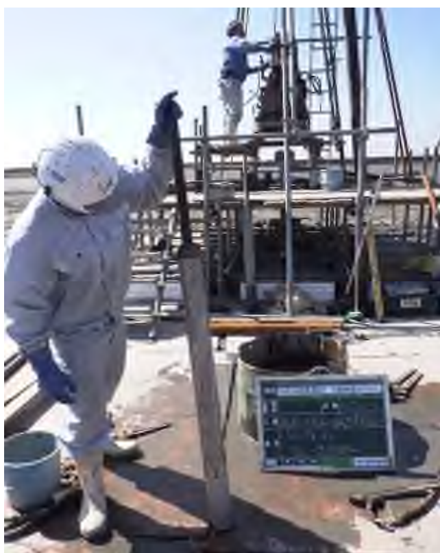
乱れの少ない試料採取（シンウォールサンプリング） (21.00～21.72m)
