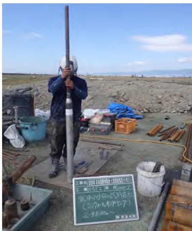
乱れの少ない試料採取 (シンウォールサンプリング) (38.00~38.80m)
