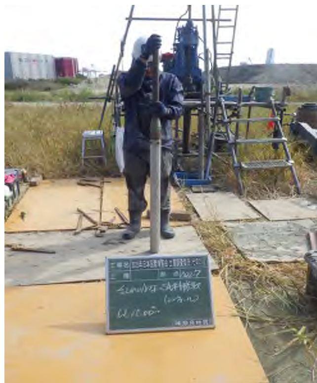
乱れの少ない試料採取 (シンウォールサンプリング) (14.00~14.65m)
