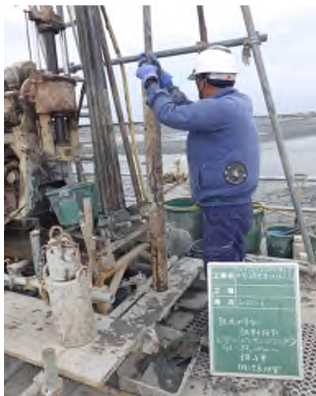
乱れの少ない試料採取（デニソンサンプリング） (29.00～29.70m)
