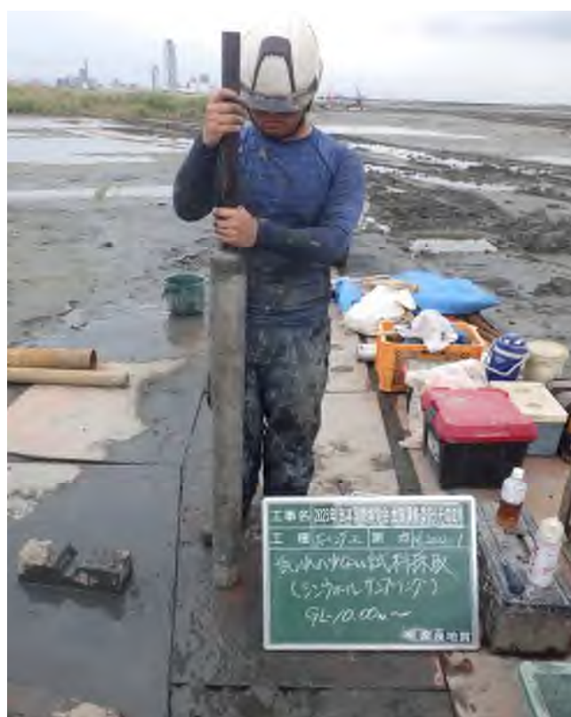
乱れの少ない試料採取（シンウォールサンプリング） (9.00~9.90m)
