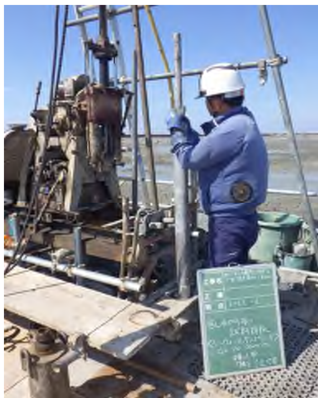
乱れの少ない試料採取（シンウォールサンプリング） (9.00～9.85m)
