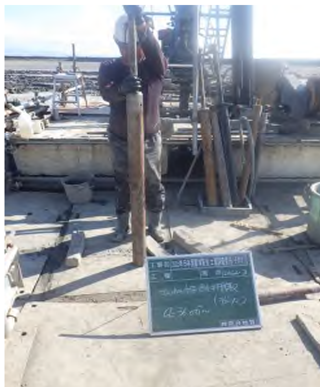
乱れの少ない試料採取（デニソン） (36.00～36.50m)
