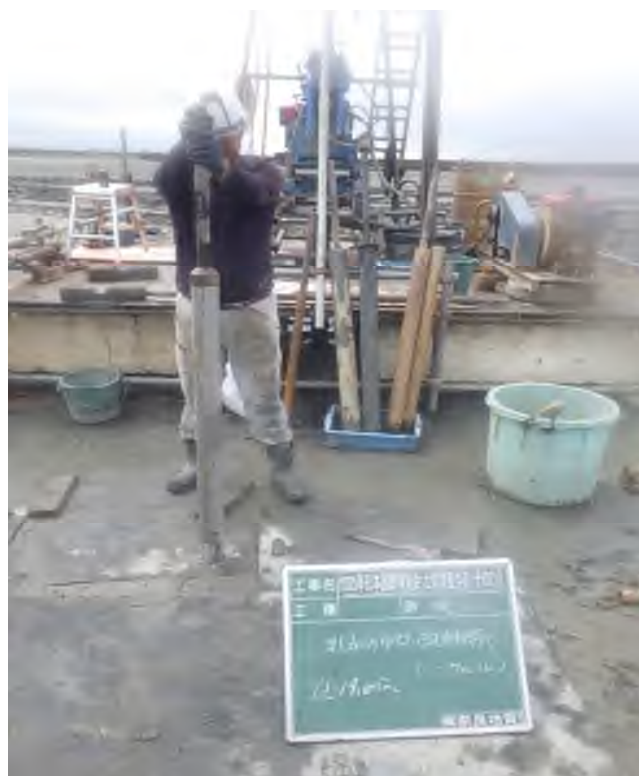
乱れの少ない試料採取（シンウォールサンプリング） (13.00～13.80m)
