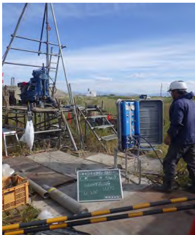
孔内水平載荷試験 (3.20~3.80m)
