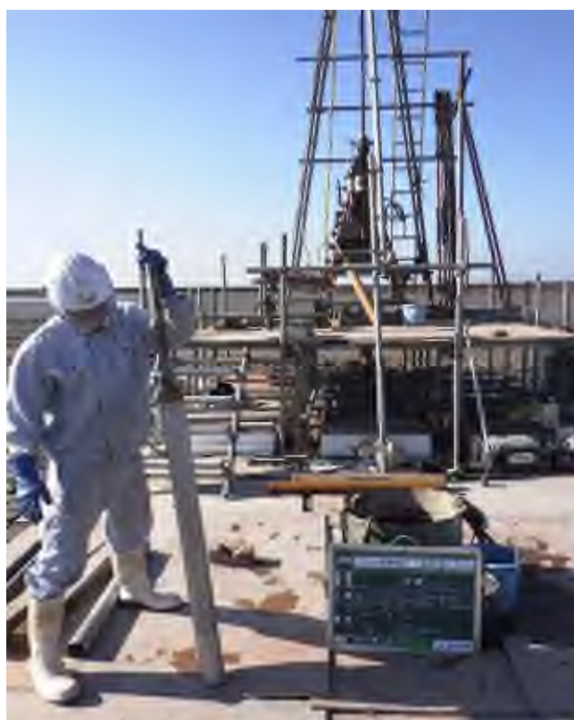
乱れの少ない試料採取（シンウォールサンプリング） (21.00～21.72m)
