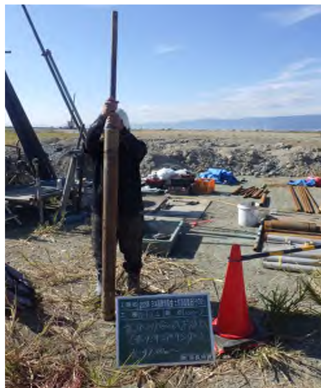
乱れの少ない試料採取（デニソンサンプリング） (29.00～29.90m)
