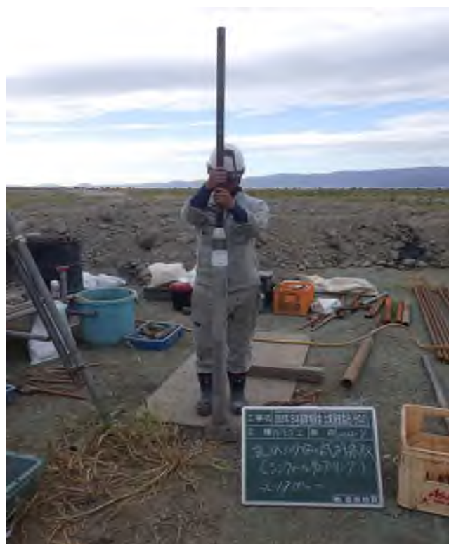
乱れの少ない試料採取（シンウォールサンプリング） (16.00～16.90m)
