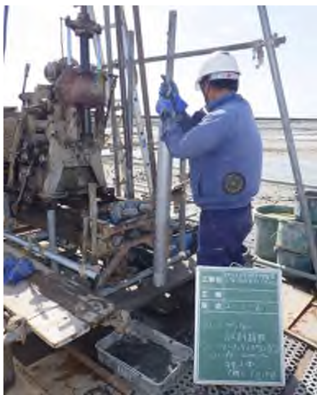
乱れの少ない試料採取（シンウォールサンプリング） (15.00~15.90m)
