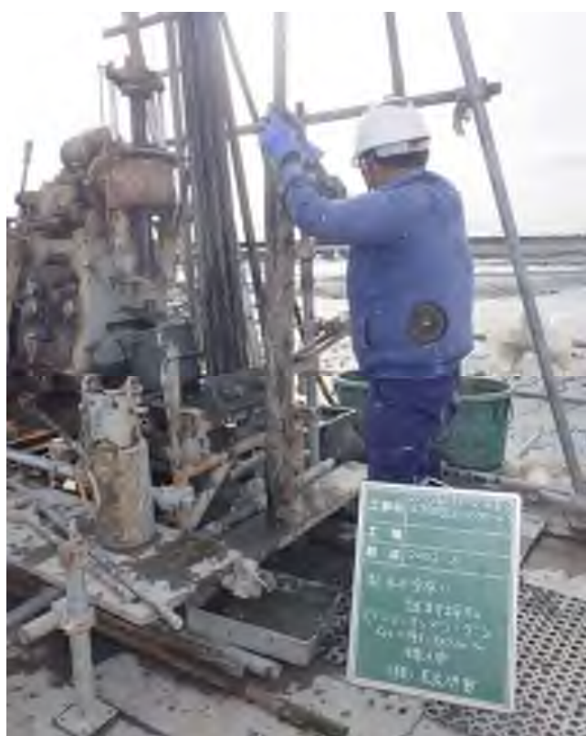
乱れの少ない試料採取（デニソンサンプリング） (41.00～41.50m)
