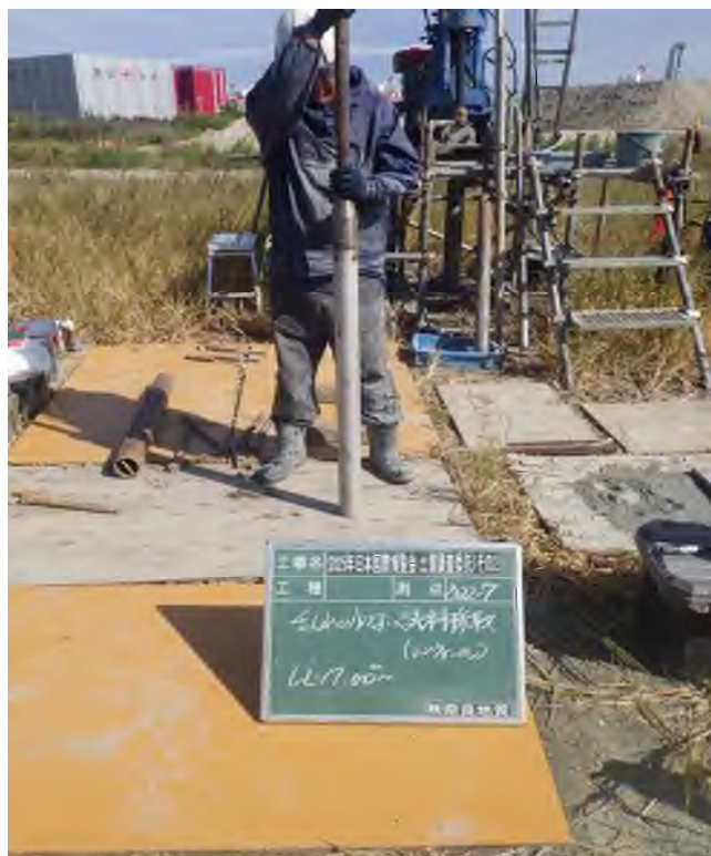
乱れの少ない試料採取（シンウォールサンプリング） (17.00～17.60m)
