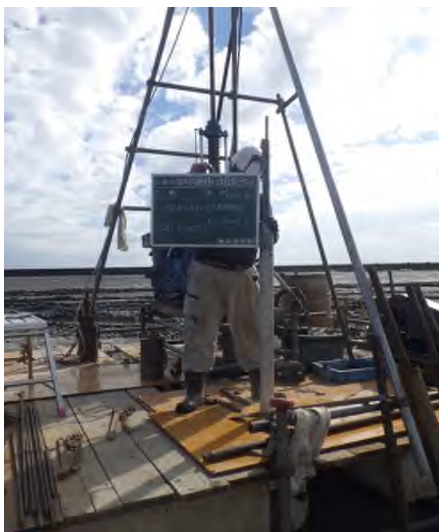
乱れの少ない試料採取（シンウォールサンプリング） (5.00～5.80m)
