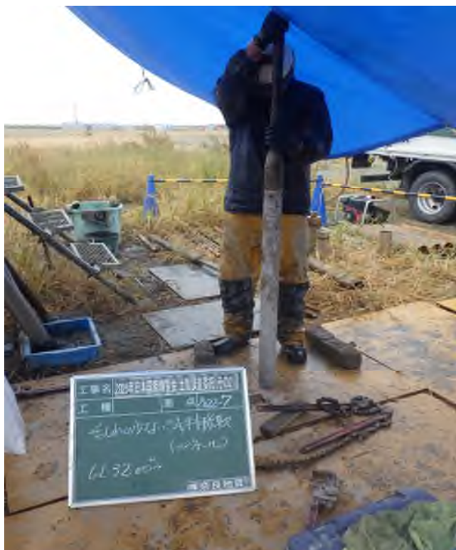
乱れの少ない試料採取（シンウォールサンプリング） (32.00～32.70m)
