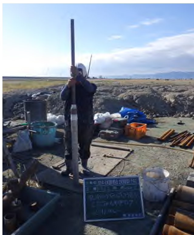
乱れの少ない試料採取 (シンウォールサンプリング) (38.00~38.80m)
