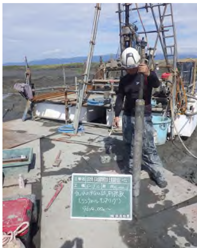
乱れの少ない試料採取（シンウォールサンプリング） (11.00～11.90m)
