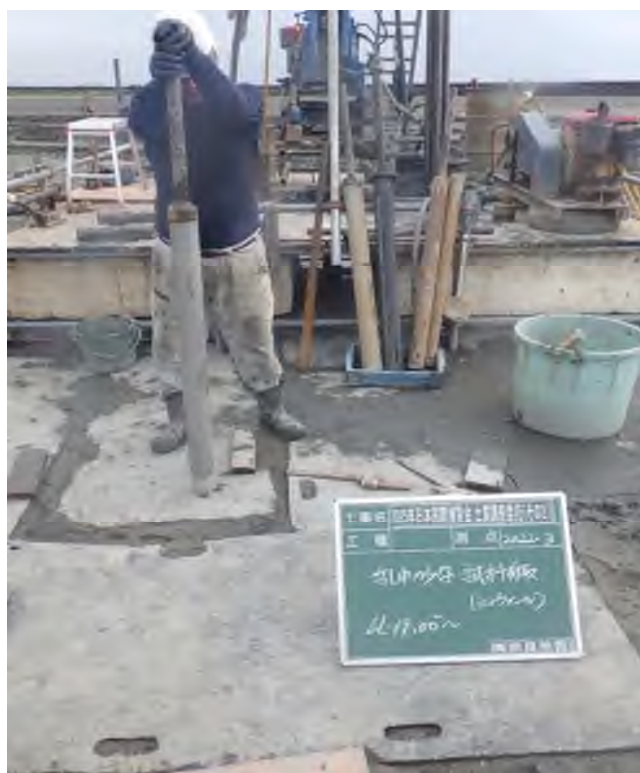
乱れの少ない試料採取（シンウォールサンプリング） (19.00～19.80m)
