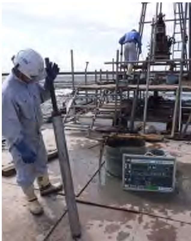
乱れの少ない試料採取（シンウォールサンプリング） (35.00～35.47m)
