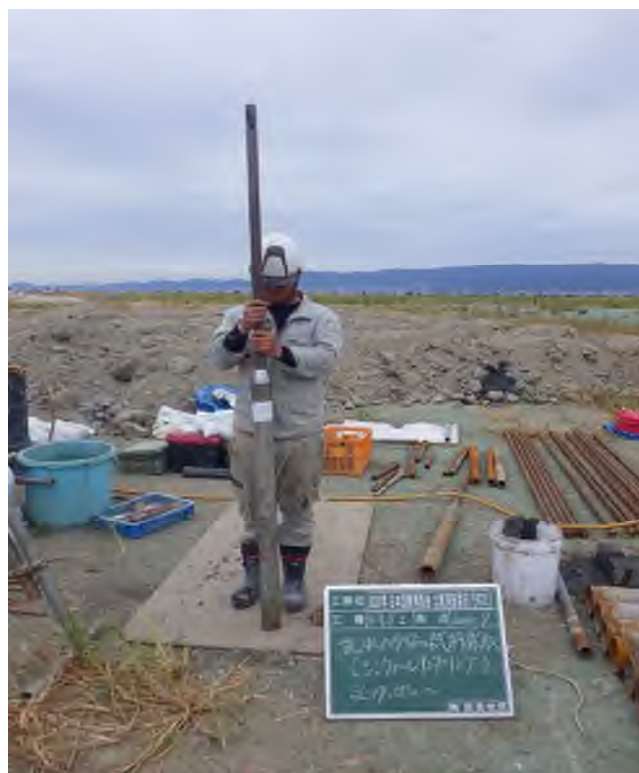
乱れの少ない試料採取（シンウォールサンプリング） (18.00～18.90m)
