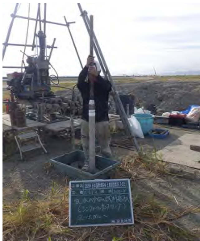
乱れの少ない試料採取（シンウォールサンプリング） (12.00～12.90m)
