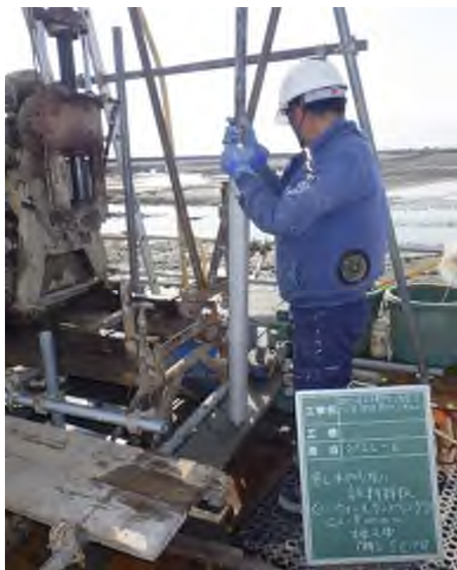
乱れの少ない試料採取（シンウォールサンプリング） (9.00～9.85m)
