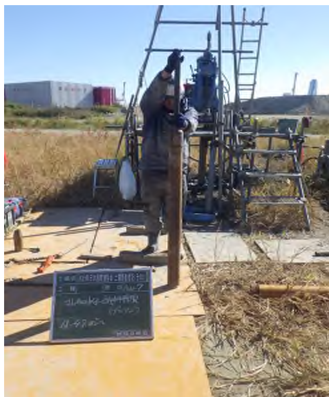
乱れの少ない試料採取（デニソン） (47.00～47.80m)
