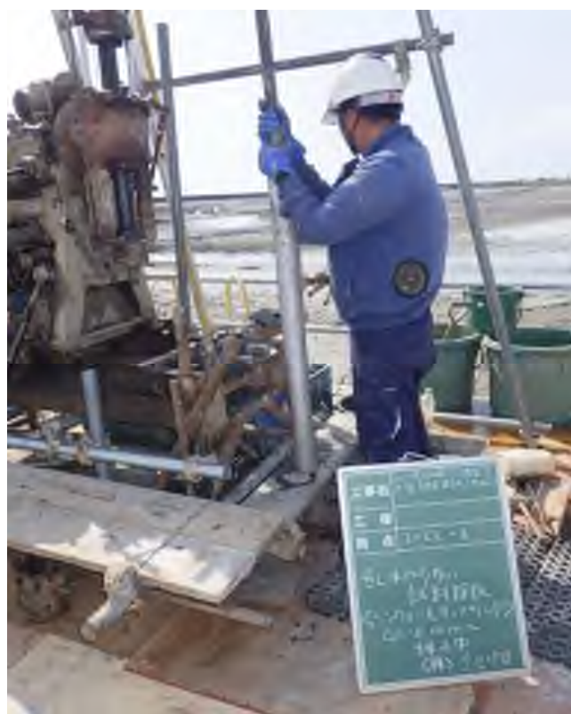
乱れの少ない試料採取（シンウォールサンプリング） (5.00～5.90m)
