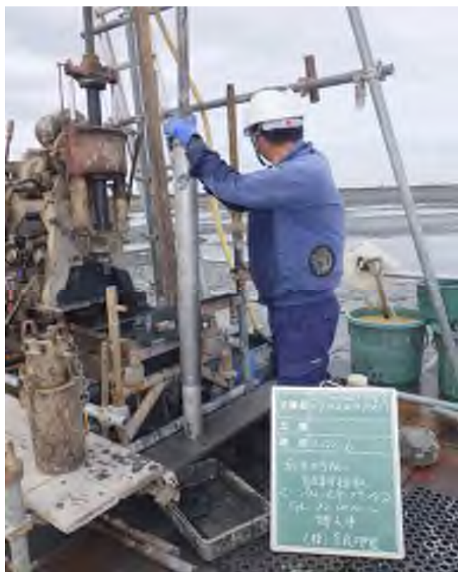
乱れの少ない試料採取（シンウォール） (22.00～22.75m)
