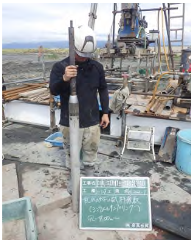
乱れの少ない試料採取（シンウォールサンプリング） (3.00～3.90m)
