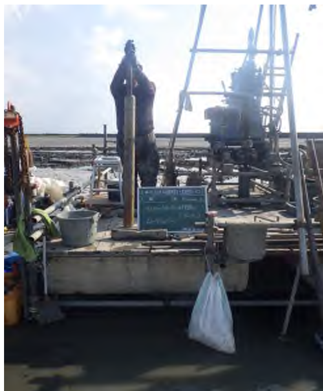
乱れの少ない試料採取（デニソンサンプリング） (39.00～39.45m)
