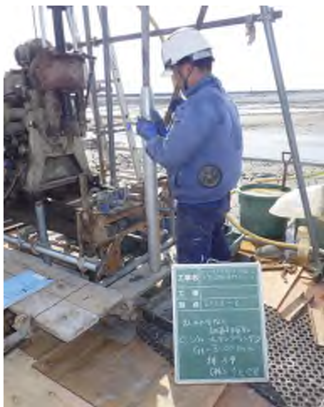
乱れの少ない試料採取（シンウォールサンプリング） (3.00~3.70m)
