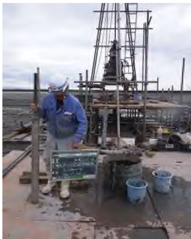
乱れの少ない試料採取（シンウォールサンプリング） (9.00～9.75m)
