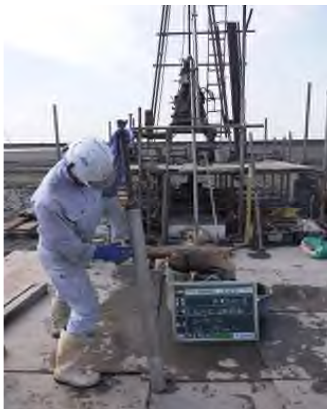
乱れの少ない試料採取（シンウォールサンプリング） (29.00～29.65m)
