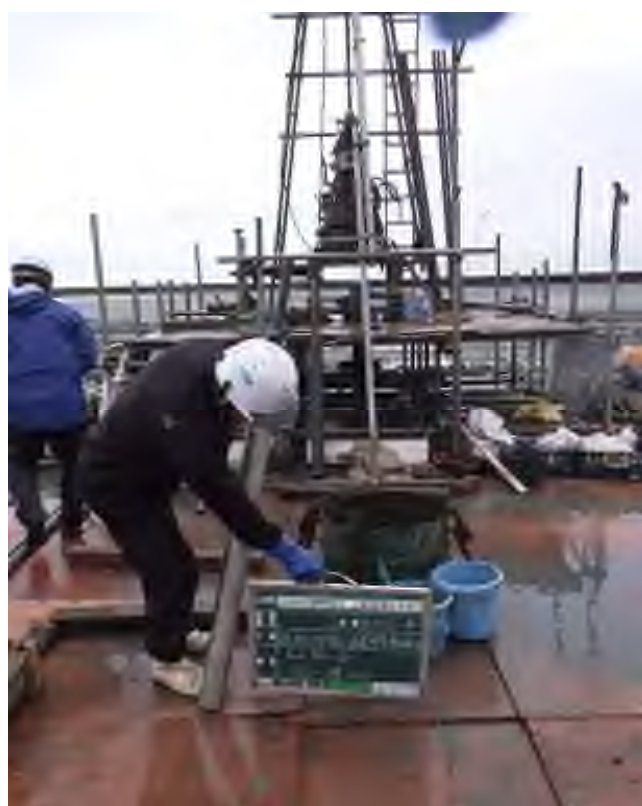
乱れの少ない試料採取（シンウォールサンプリング） (13.00～13.76m) (14.00～14.77m)
