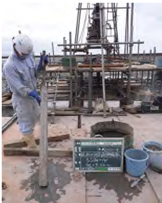
乱れの少ない試料採取（シンウォールサンプリング） (7.00～7.77m)
