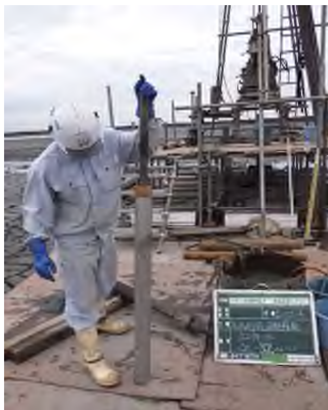
乱れの少ない試料採取（シンウォールサンプリング） (29.00～29.65m)
