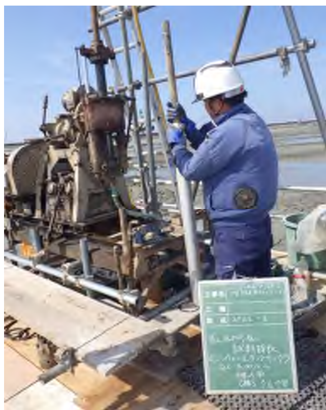
乱れの少ない試料採取（シンウォールサンプリング） (3.00~3.70m)
