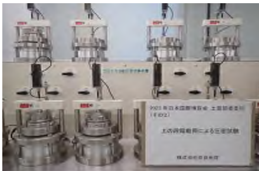
土の段階荷重による 圧密試験 JIS A 1217
