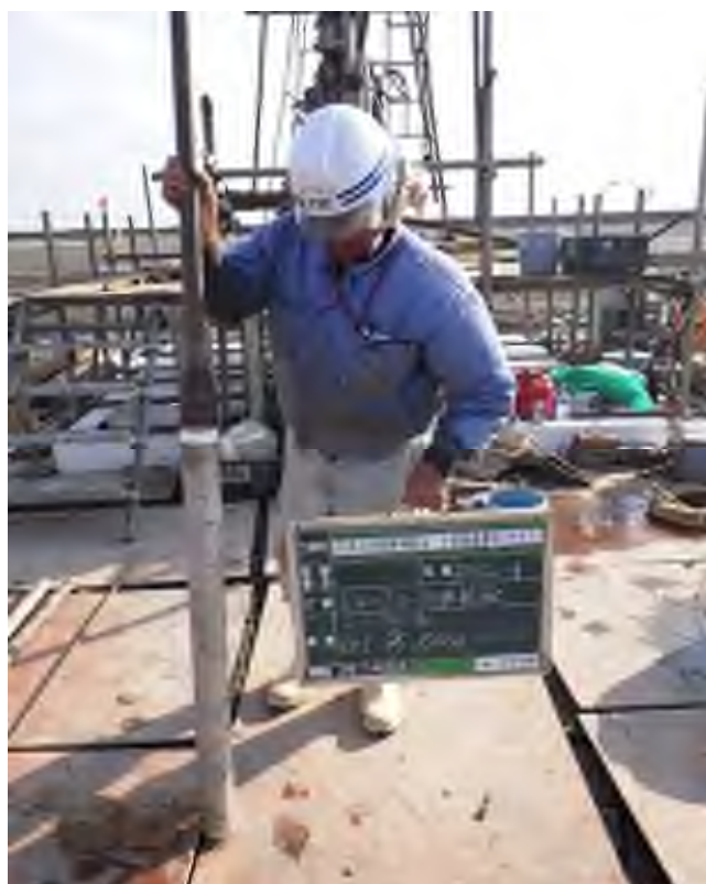
乱れの少ない試料採取（シンウォールサンプリング） (3.00～3.89m)
