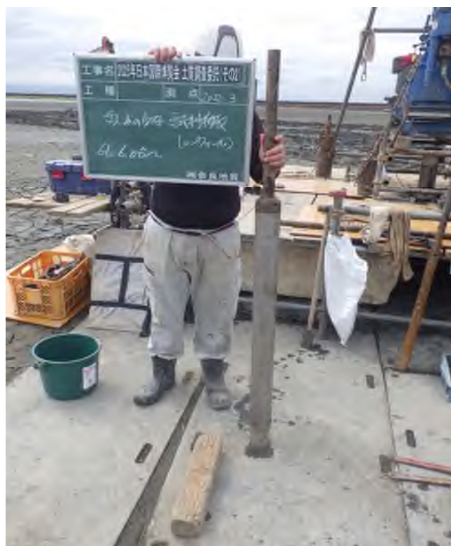
乱れの少ない試料採取（シンウォールサンプリング） (5.00～5.80m)
