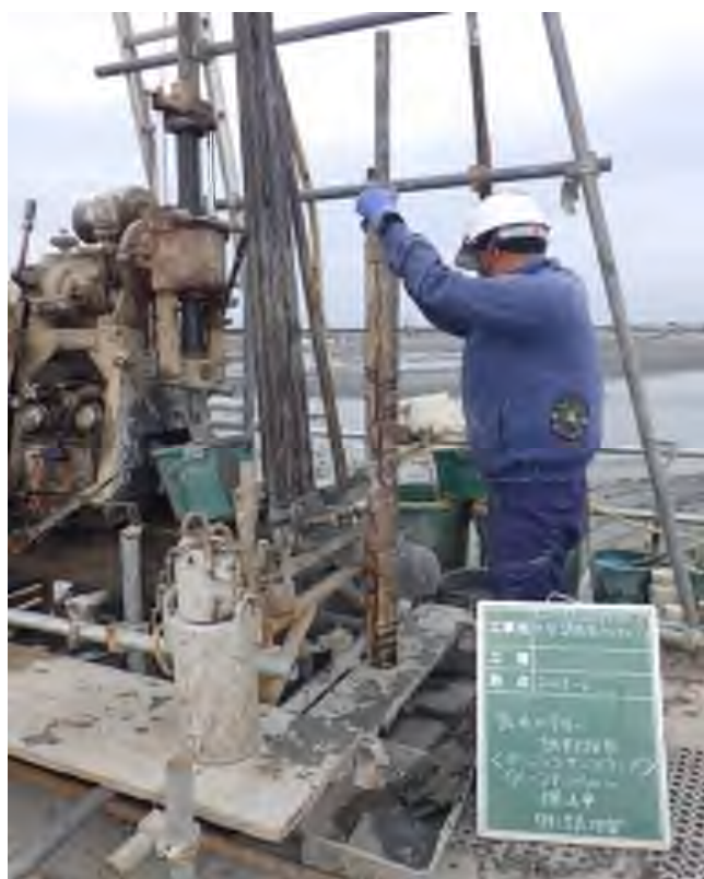
乱れの少ない試料採取（デニソンサンプリング） (29.00～29.70m)
