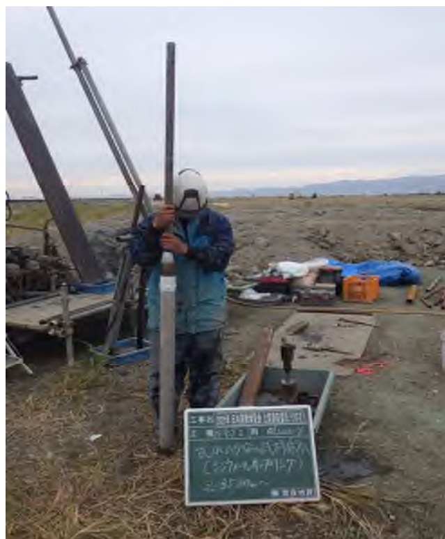
乱れの少ない試料採取 (シンウォールサンプリング) (32.00~32.80m)
