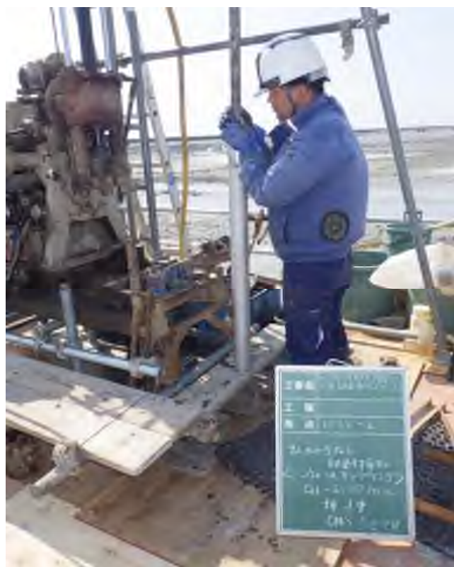
乱れの少ない試料採取（シンウォールサンプリング） (1.00~1.80m)
