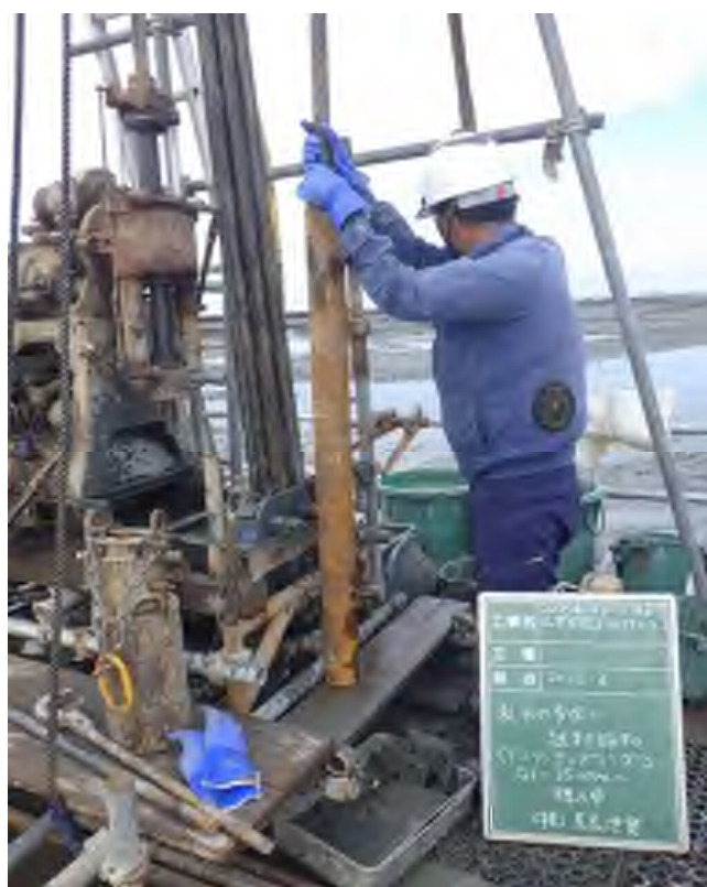
乱れの少ない試料採取（デニソンサンプリング） (35.00～35.40m)
