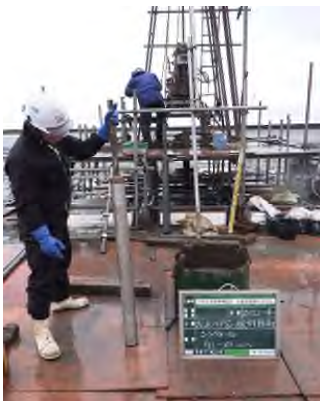
乱れの少ない試料採取（シンウォールサンプリング） (13.00～13.76m) (14.00～14.77m)
