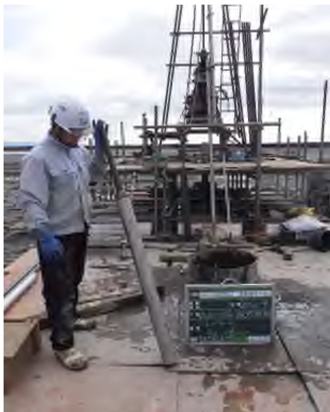
乱れの少ない試料採取（シンウォールサンプリング） (19.00～19.77m)
