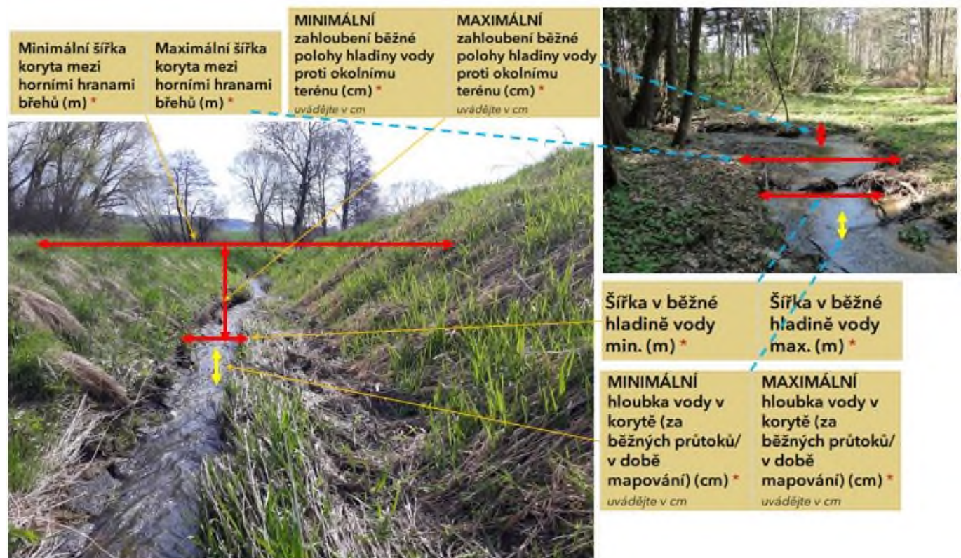
Obr. 33: Parametry koryta - rozpětí min. a max. hodnot reprezentující příčný profil v úseku
