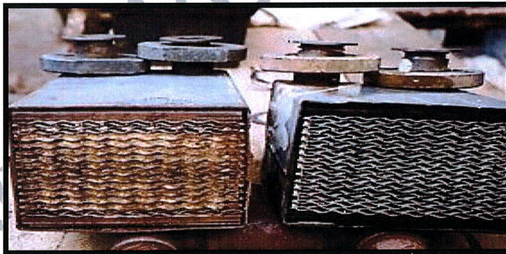
Deskový výměník před a po čištění:
