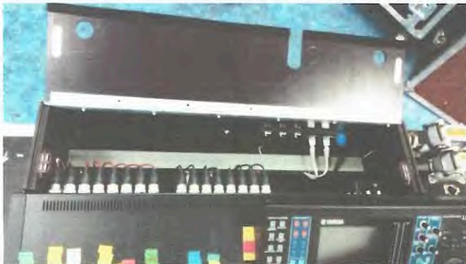
Odklápěcí víko, pohled na ovor pro kabeláž mezi kostkou a konektorovým prostorem.
