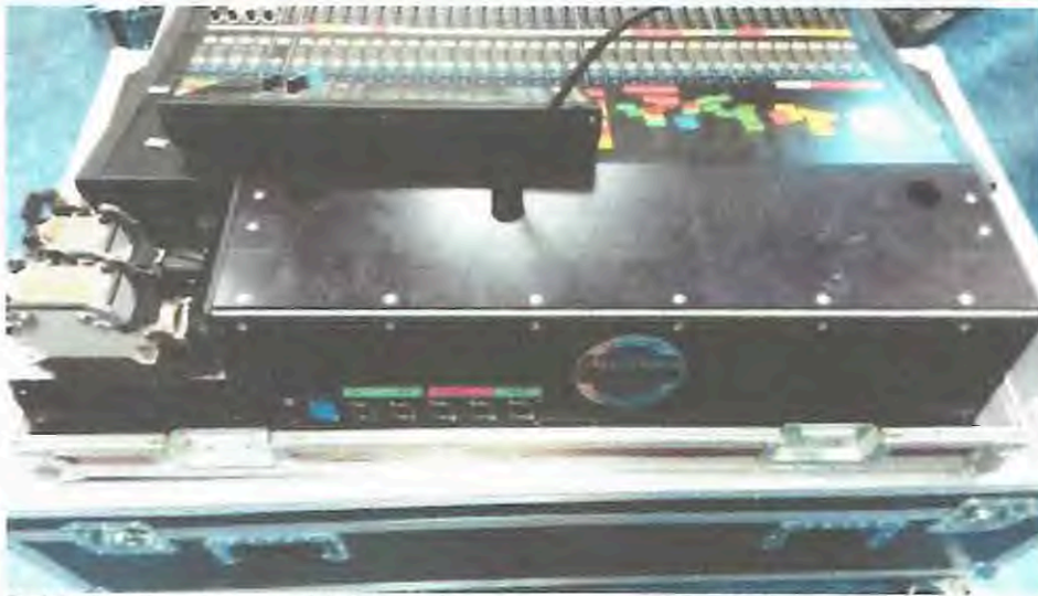
Pohled na kostku s multipiny a víko s otvorem pro lampičku.
