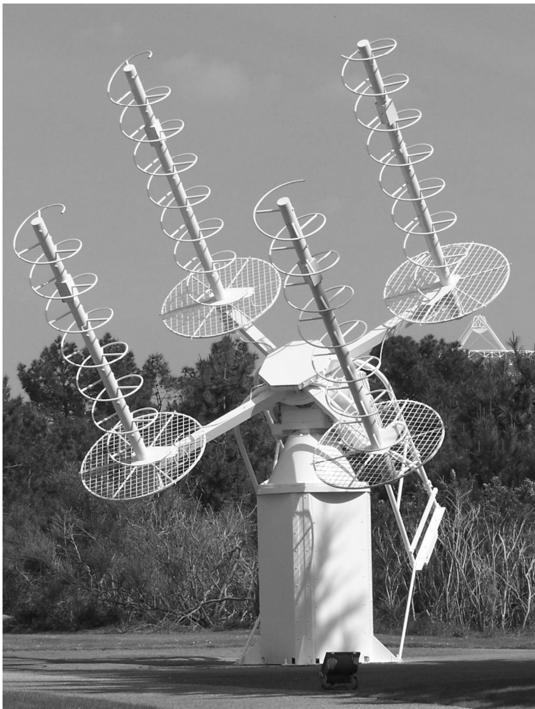
Obr. 4: Ukázka profesionálního anténního systému pro UHF pásmo v provedení se 4 anténami typu Helix.
