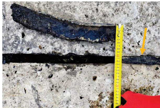
Foto č. 3 – Vzorek astarové závlivky vyjmutý ze spáry. Odtřzení závlivky od stěny dilatační spáry (viz šipka).
