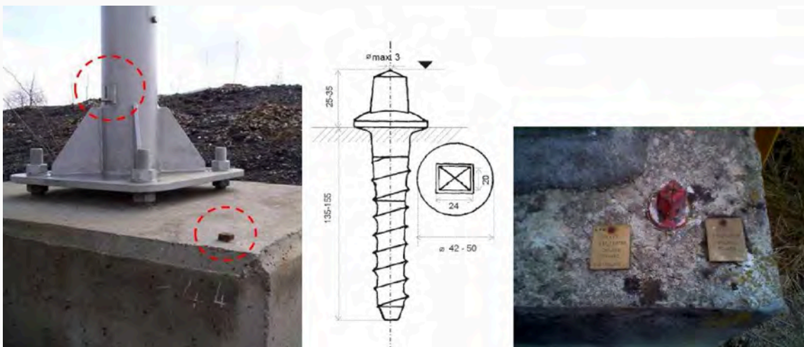
Obrázek 10 Konzole na podpěře trakčního vedení a vrtule v betonovém základu
