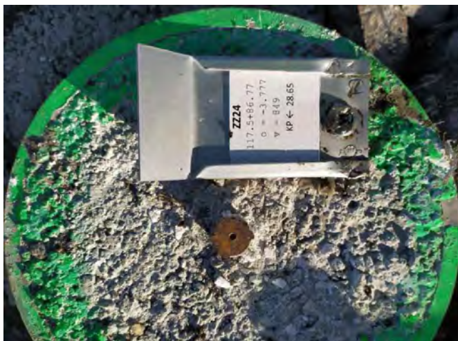
Obrázek 33 Roxor v betonovém bloku (základní odlehčená stabilizace)
