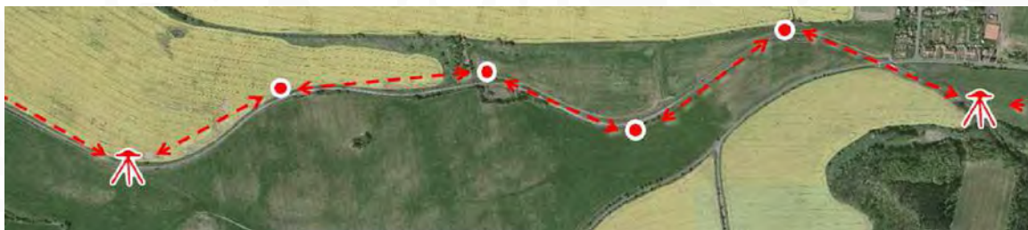
Obrázek 1 Polygonové body mezi dvěma body primární sítě
