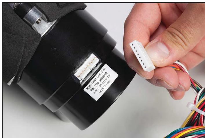
Obr. 8-32 Obrázek konektoru pumpy před připojením (nahore), připojeného, ale nesprávně usazeného s jedním odkrytým kolíkem (vlevo dole) a správně usazeného (vpravo dole)
