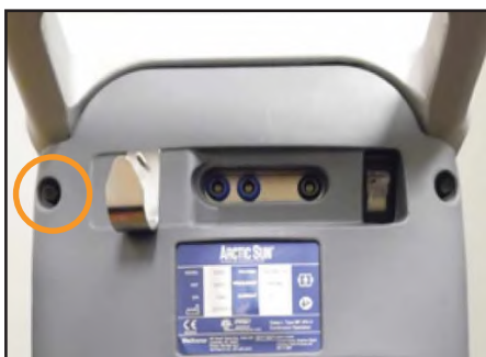
Obr. 8-72 Odstraňte šroub (krok 1)
