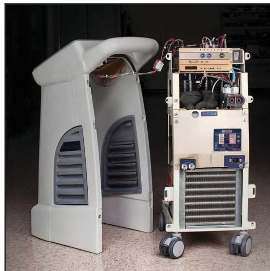
Obr. 8-13 Plášť oddělen od vnitřních součástí
