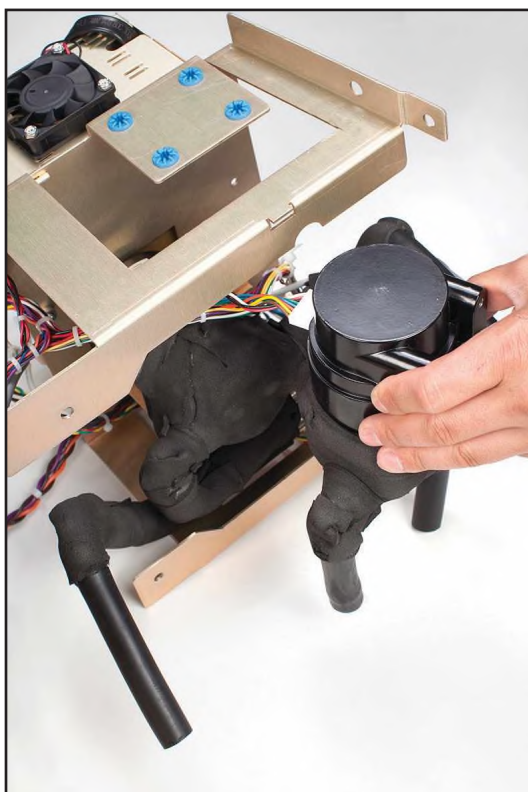
Obr. 8-31 Opatrně vyjměte směšovací pumpu (krok 5)
