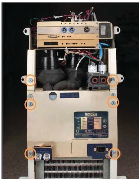
Obr. 8-19 Odstraňte šest šroubů (krok 1)
