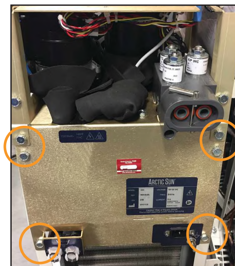
Obr. 8-36 Odstraňte šest šroubů (krok 3)
