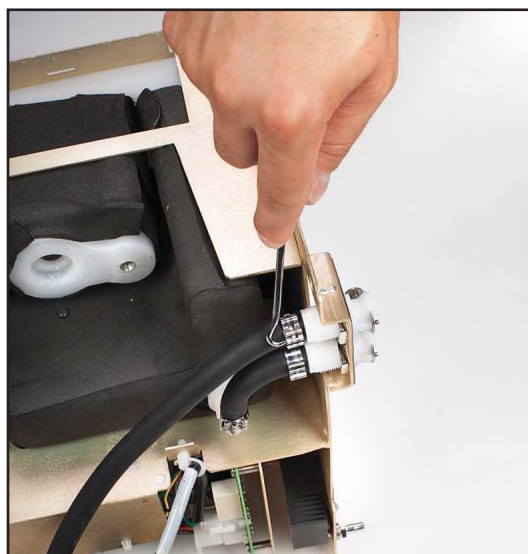
Obr. 8-43 Otevřete svorku spojující hadičku pumpy chladiče s vypouštěcím ventilem
