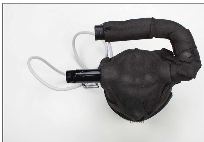
Obr 8-53 Průtokoměr se šipkou ukazující směr průtoku; stejný směr jako výstup oběhové pumpy.
