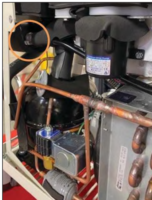
Obr. 8-22 Odpojte dvě svorky (krok 3 – pumpa DC)
