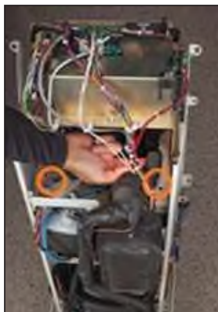
Obr. 8-17 Odstraňte dva šrouby (krok 2)
