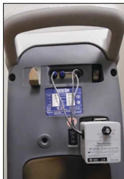
Obr. 9-3 Připojte kabely (krok 2)
