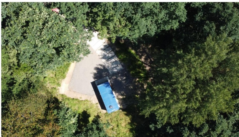
Ilustrační foto: Kontejnerová jednotka pro automatickou koagulaci fosforu v přírodní vodoteči (v.n. Jordán, Tábor – realizace 2023).
