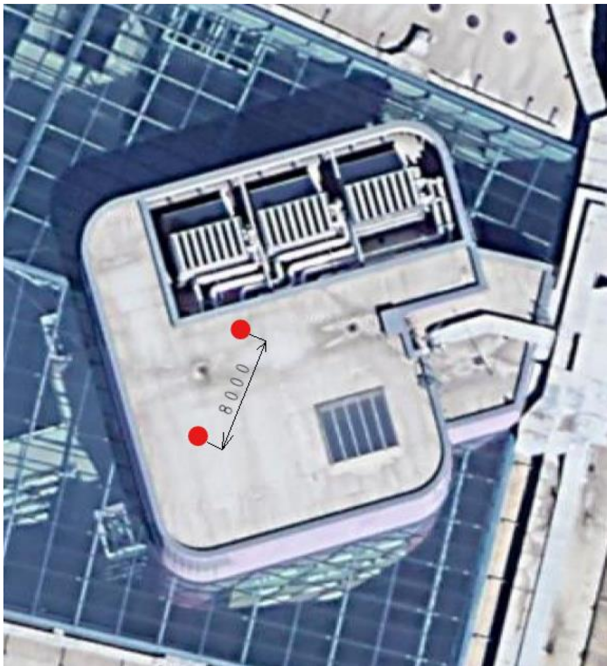
Obr. 7 Půdorys červené nástavby střechy s umístěním antén
