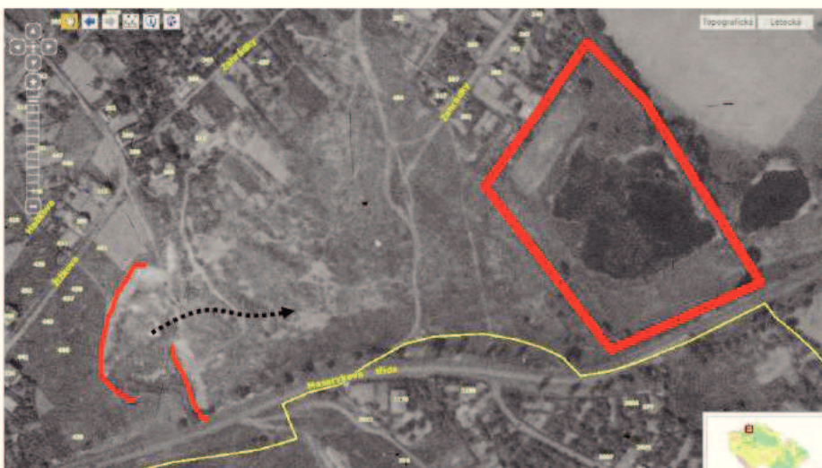
Obr. 5: Ortofotomapa z 50. let dvacátého století, na které je zřetelné vidět horní odlišná část sesuvu (odlišné hrany jsou naznačeny červenými liniemi a směr pohybu černou čárkovanou linií). Červeným polygonem je znázorněn přibližný rozsah plánovaného využití území, v jehož ploše je starý, ještě v té době nezavezený oprám ( https://ags.cuzk.cz/archiv/ ).
