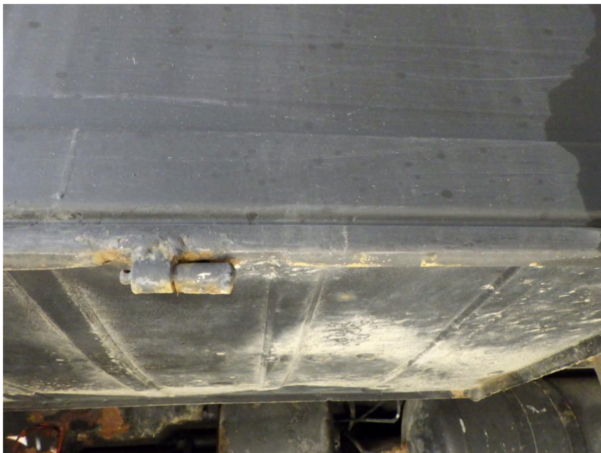
11 - Oprava spodní části levé strany kabiny
