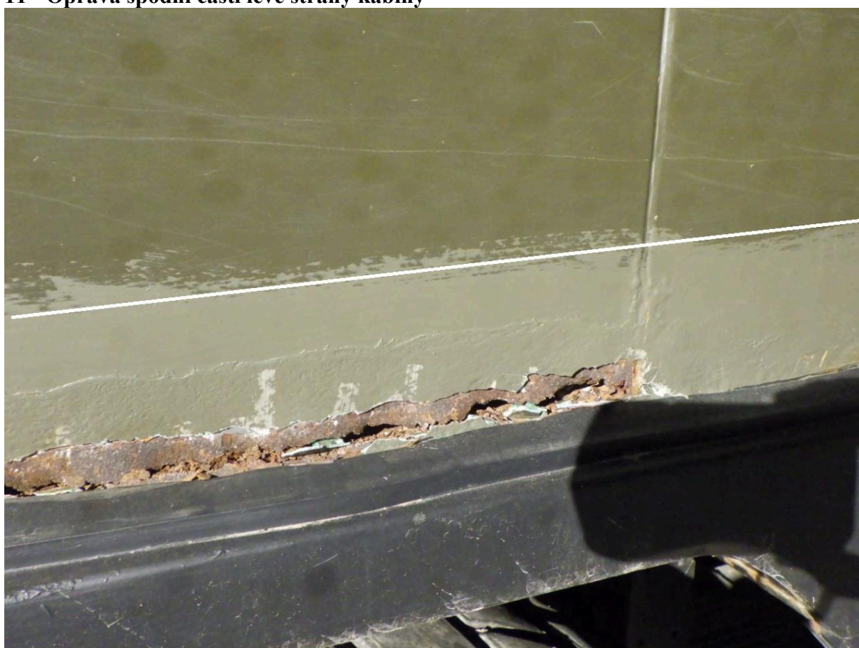
11 - Oprava spodní části levé strany kabiny
