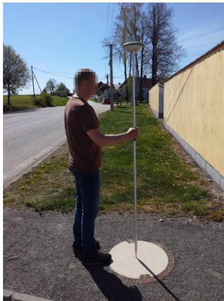
Obr. 2: Ukázka zaměření SVB technologií GNSS.
