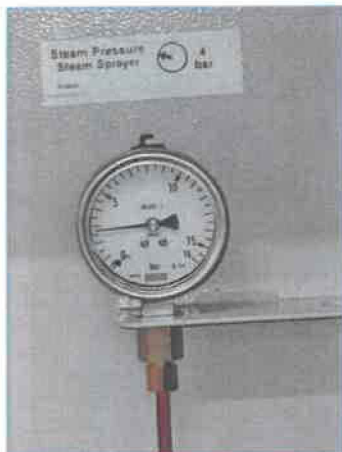
Obrázek číslo 4: Dokumentace poklesu tlaku páry na rozdělovači finišeru na 2,7 bar
