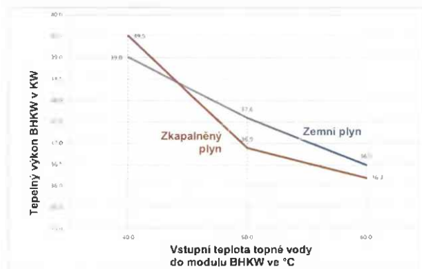
Obr. 1 Tepelný výkon BHKW v závislosti na teplotě vstupu topné vody do modulu BHKW
