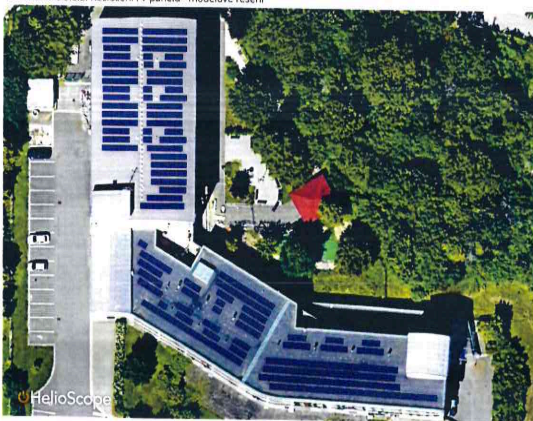
Obrázek č. 3.3.8.3: Rozložení FV panelů - modelové řešení
