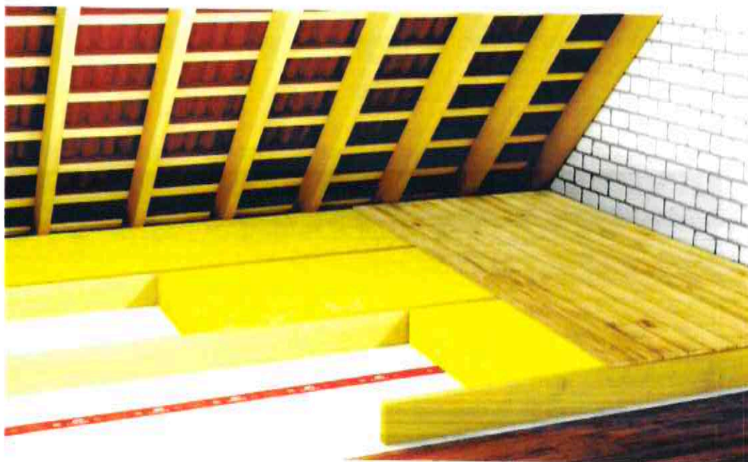
Obrázek č. 3.3.3.1: Znázornění modelové skladby zateplení stropu pod nevytápěným prostorem (Zdroj: izolace-info.cz)
