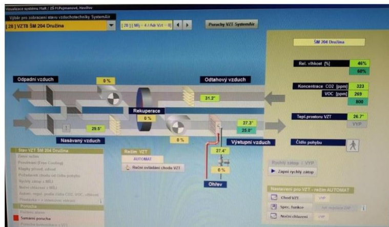
Obrázek 117: Vizualizace na PC (VZT zařízení)
