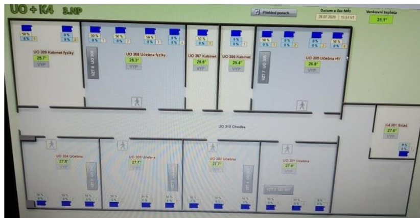
Obrázek 113: IRC regulační systém IRC (vizualizace na PC)
