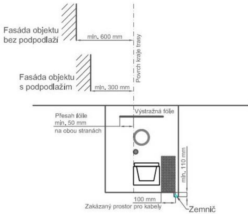
Obrázek 6 Společná pravidla pro uložení kabelů
