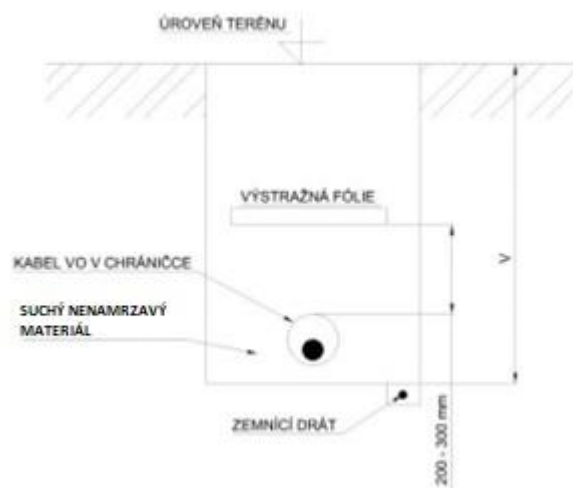
Obrázek 7 Vzorové řezy uložení kabelů
