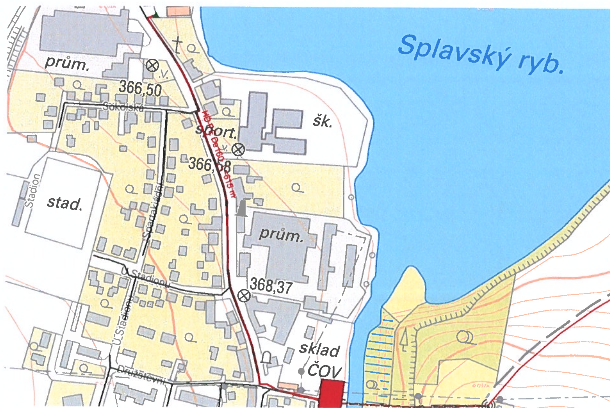
Obr. 2 Trasa navýšení dimenze stávajícího kanalizačního výtlaku
