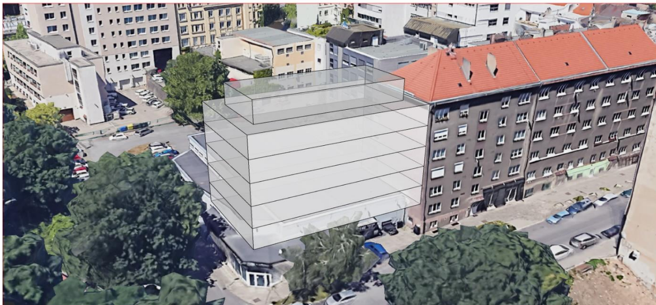
Obr. 4: Schematický model možnosti nástavby 5NP + ustoupené podlaží
