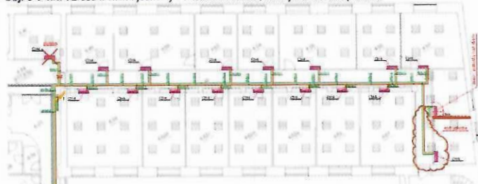
Obj. C v 4.NP: zrušení vnitřní jednotky v místnosti serveru, nová jednotka ve spísovně.
