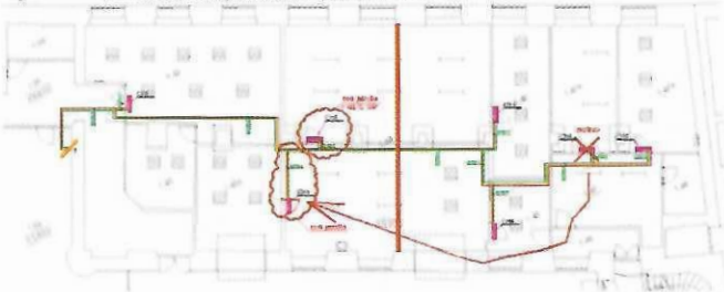
Obj. C v 2.NP: zrušení vnitřní jednotky v místnosti serveru.
