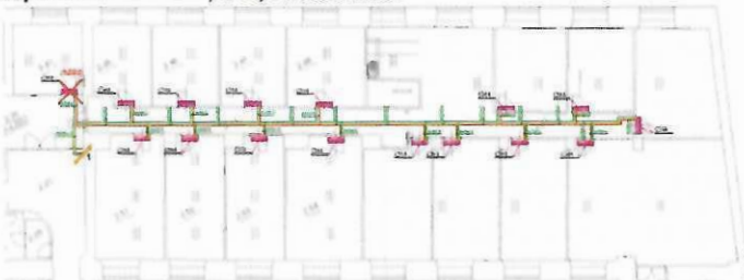
Obj. C v 3.NP: zrušení vnitřní jednotky v místnosti serveru.
