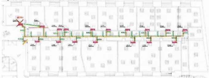
Obj. C v 4.NP: zrušení vnitřní jednotky v místnosti serveru, nová jednotka ve spísovně.
