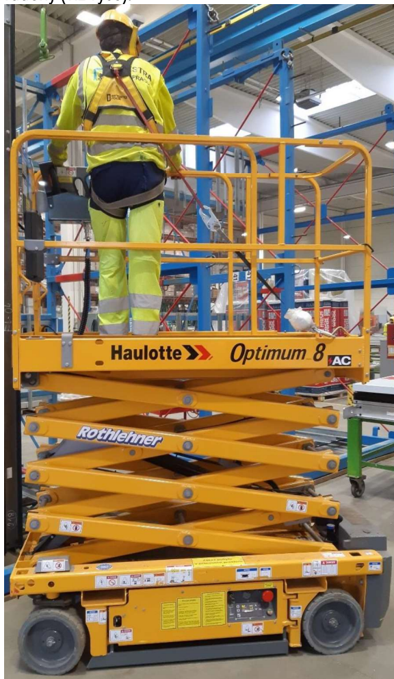
Příklad: Vzor osobního zajištění v pracovním koši mobilní plošiny.
