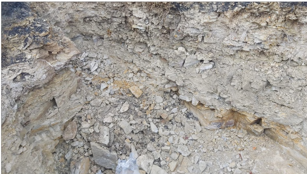
Obr. 4 Polohy tvrdých spongilitických slínovců (světle šedé) s těžitelností 6. třídy (ČSN 73 3055) v hlubší úrovni stavební rýhy (1,800 km).
