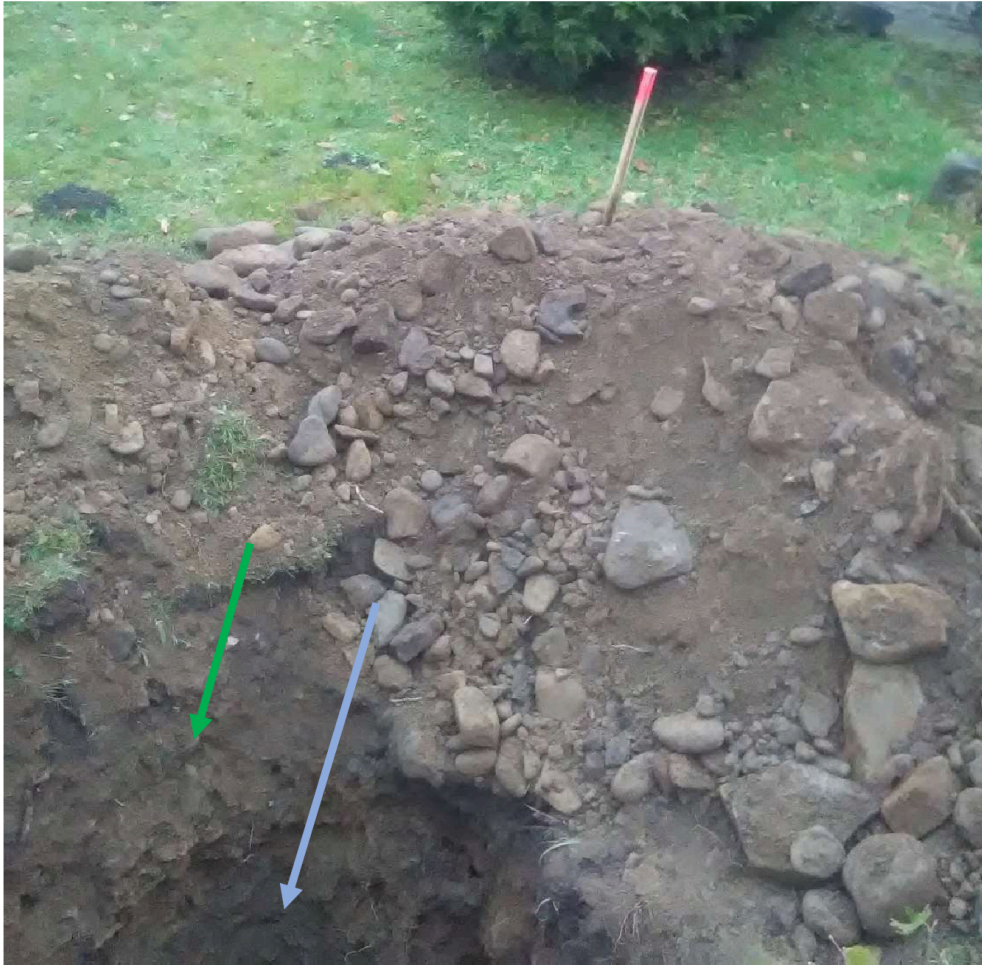
Obrázek 5 otevřený výkop se značením jednotlivých typů zemin (zelená – tř. 2-3, modrá – tř. 4, červená – tř. 5)
