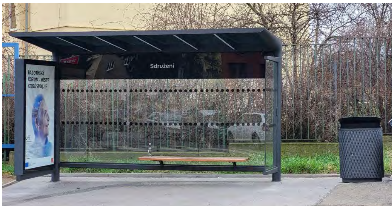
Nový návrh pražských zastávek PID s lavičkou, reklamní plochou, bočním panelem a odpadkovým košem (Zdroj: Autor)
