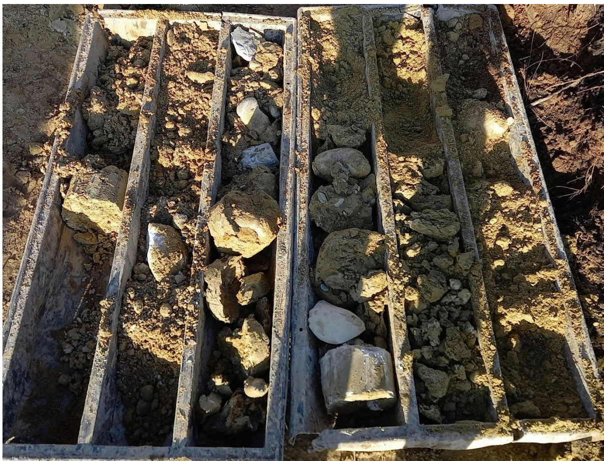
Foto 8 Profil vsakovací sondy VS-4
