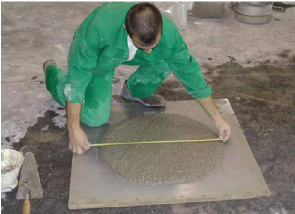
(3) Obr. 3 – Zkouška rozlití SCC - správně navržená směs
