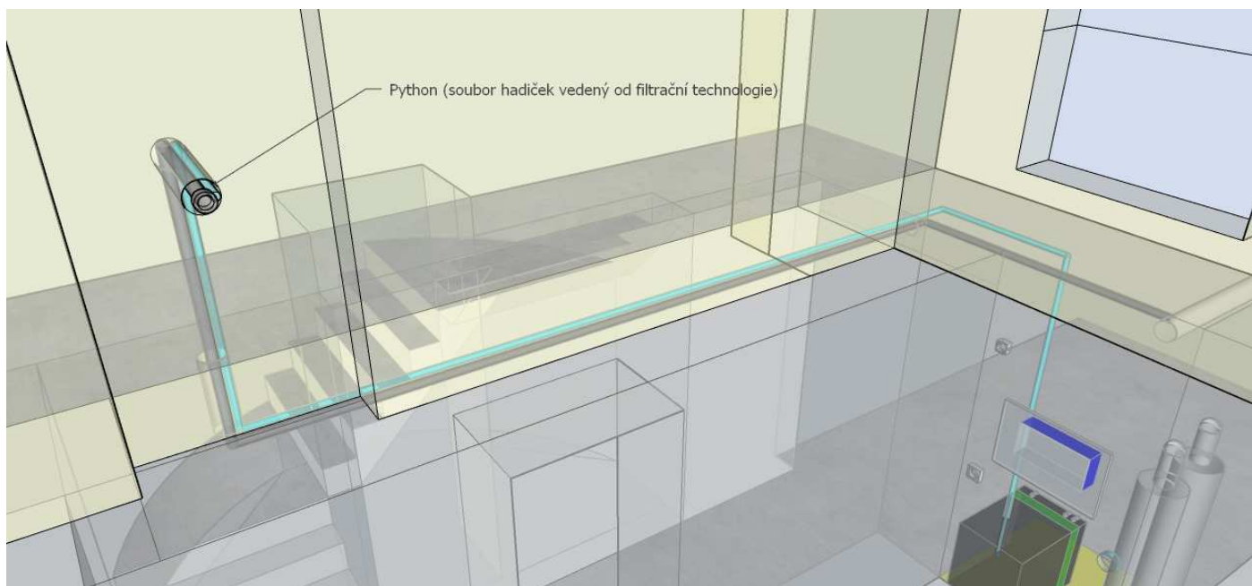
Obr.7 – tažený python (soubor hadiček s filtrovanou vodou)
