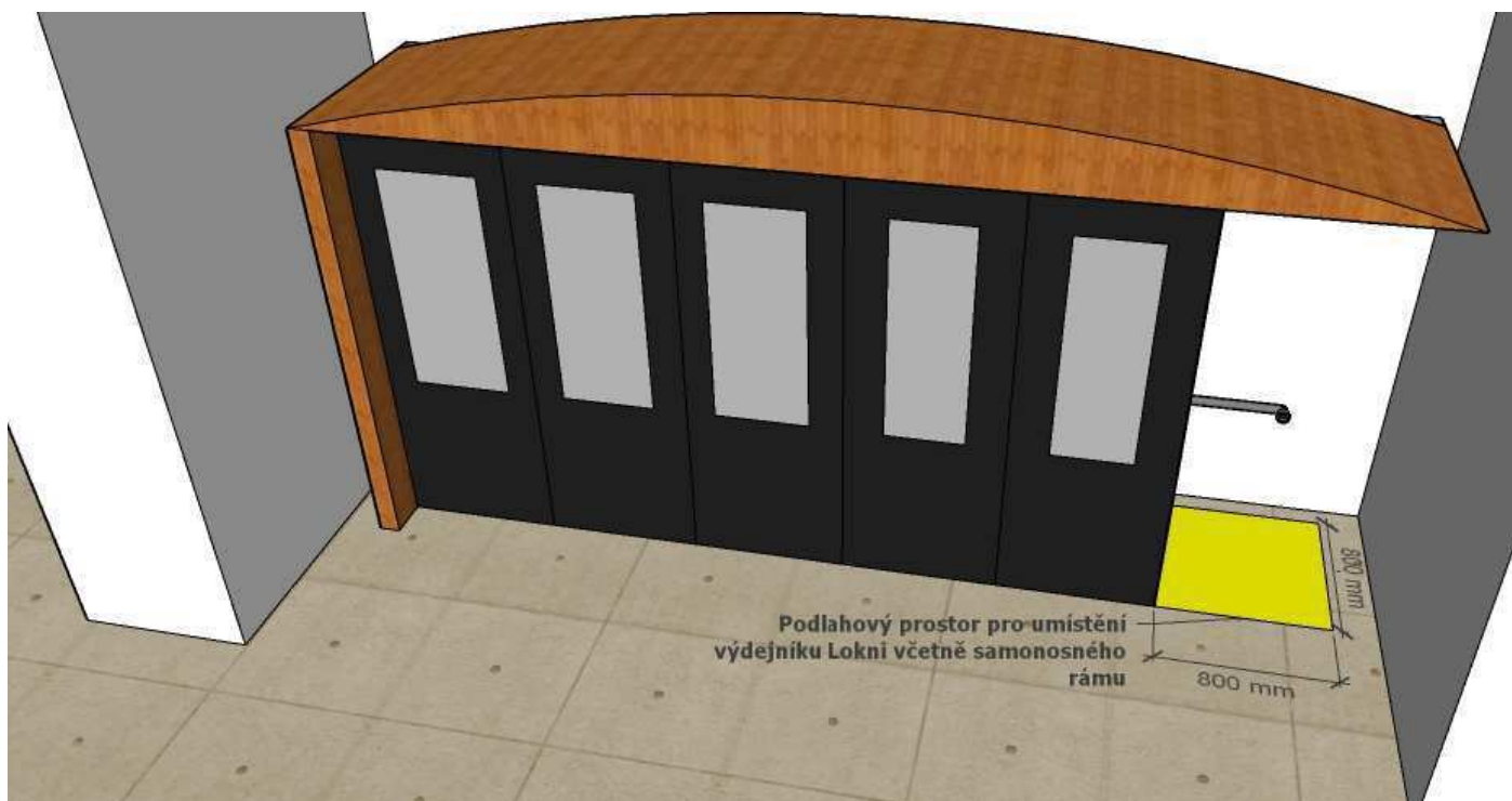
Obr.6 – ideální rozměry podlahové plochy pro umístění výdejníku na rámu
