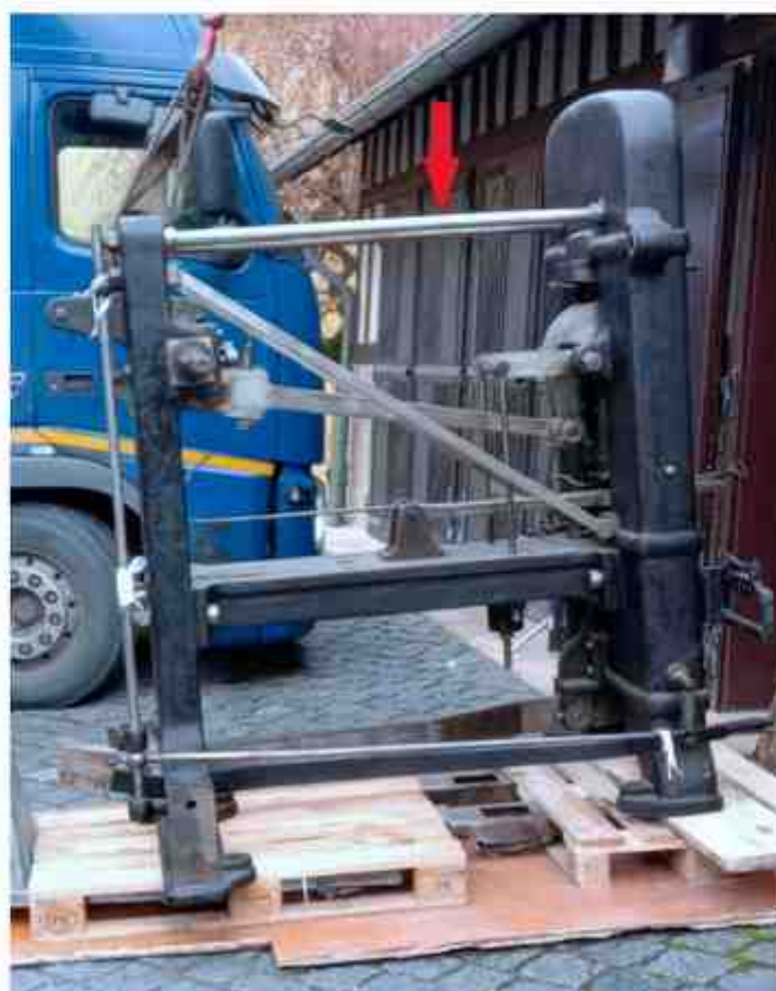
Obrázek 4, Detail prohnutí rozpěrné tyče
