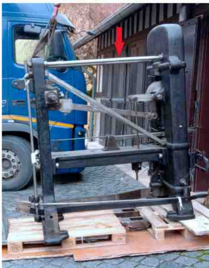
Obrázek 5, Detail mírného prohnutí rozpěrné tyče
