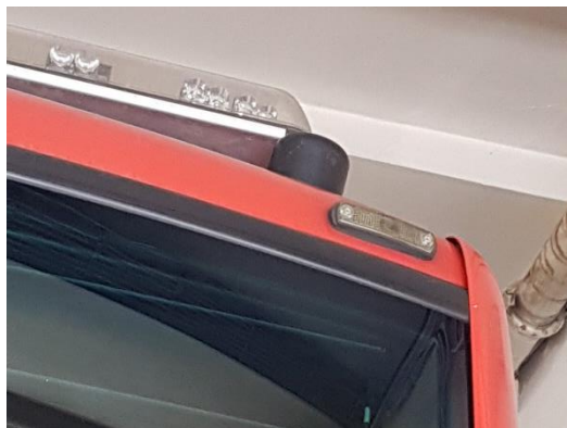
Obrázek 3 – Umístění multi-antény na střeše pod majákem.
