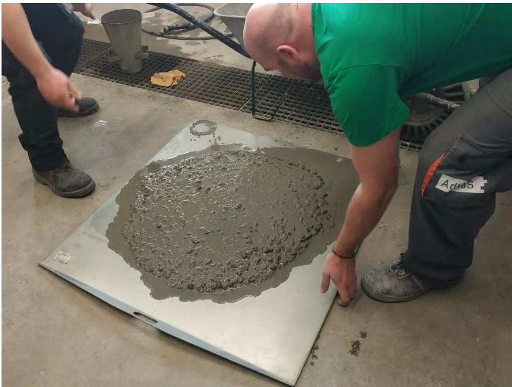
(6) Obr. 6 – Zkouška rozlití SCC - nesprávně navržená směs, vysoká náchylnost k bleedingu (po obvodu vystupuje cementové mléko) a segragaci (shluky hrubých zrn kameniva)
