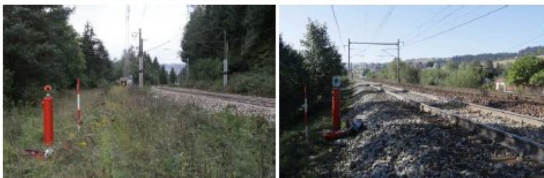
Obrázek 38 Piliře s nucenou centrací na aktuálně probíhající stavbě na Slovensku
