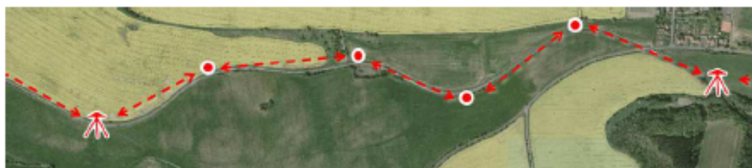
Obrázek 1 Polygonové body mezi dvěma body primární sítě
