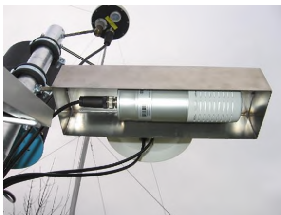
Obr. 24 Snímač koncentrací CO 2 od firmy Vaisala, chráněný před povětrnostními vlivy stříškou z nerezového plechu.
