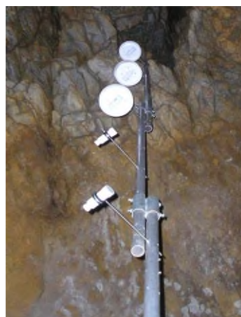
Obr. 6 (vlevo) Umístění teplotních čidel v interiéru jeskyně – jedna výška. Obr. 7 (vpravo) Umístění teplotních čidel v interiéru jeskyně – vertikální profil.
