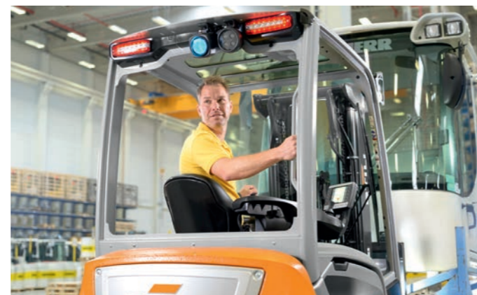
Otočné sedadlo s na přání dodávaným ovládním houkačky umožňující bezpečnou jízdu vzad
