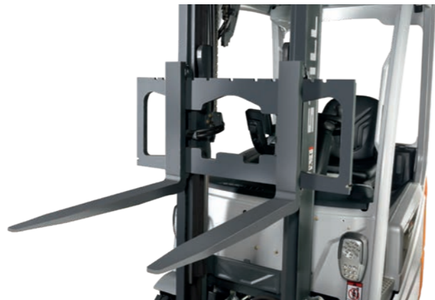
Optimální výhled na hroty vidlic při nakládání na nákladní vůz
