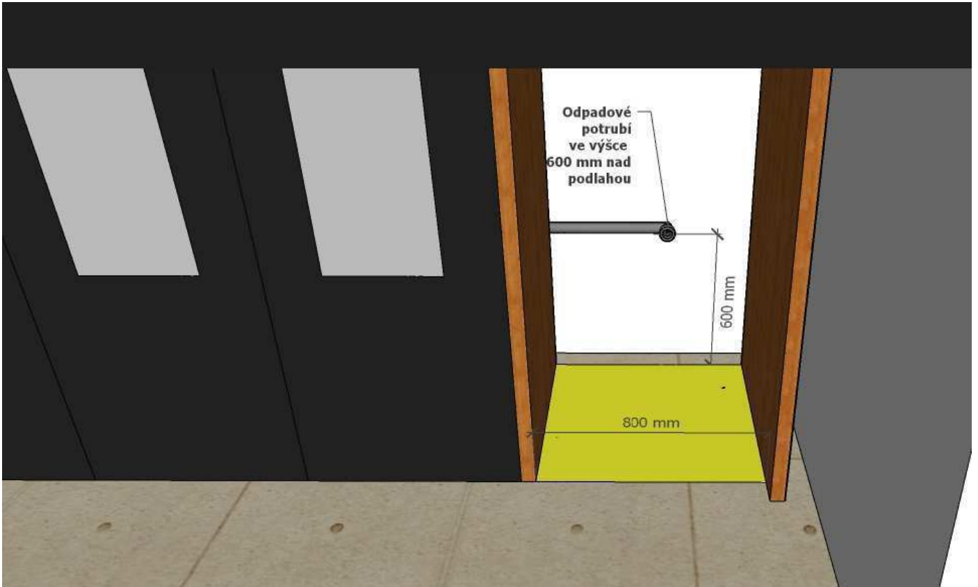
Obr.2,3 – Vyvedené odpadové potrubí
