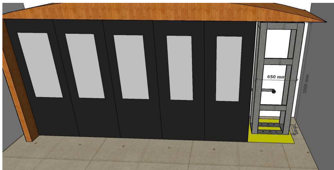
Obr. 5 – jeklový rám – umístění v prostoru boxu pro automaty
