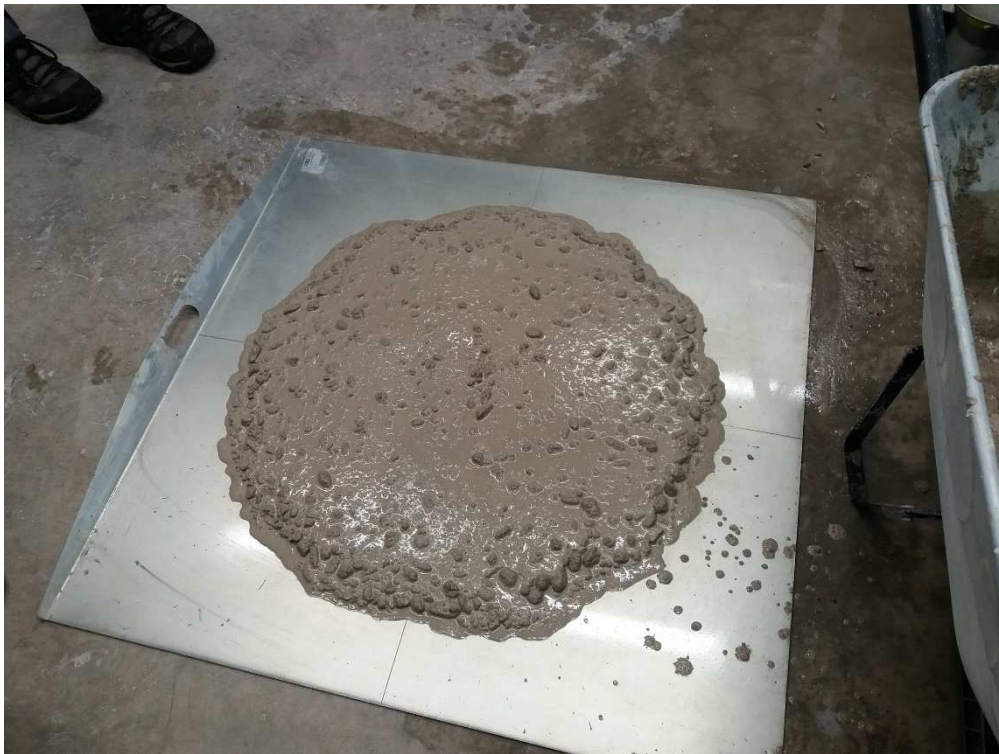
(5) Obr. 5 – Zkouška rozlití SCC - nesprávně navržená směs, zjevná náchylnost směsi k bleedingu
