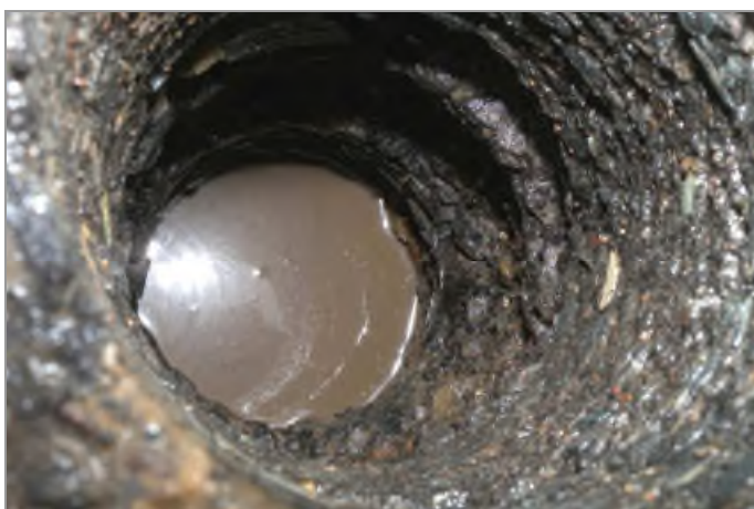
foto 17, 18: Pohled do ústí svislého vrtu J-4 pro ověření skladby silničního tělesa za opěrou mostu a detail jádra vrtů J-3 (ve vrcholu klenby mostu) resp. J-4 (za opěrou mostu)
