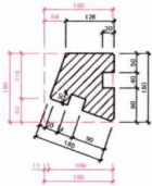
levý zadní dřevěný sloupek hranol KVN TRIO 180/180 M 1:5
