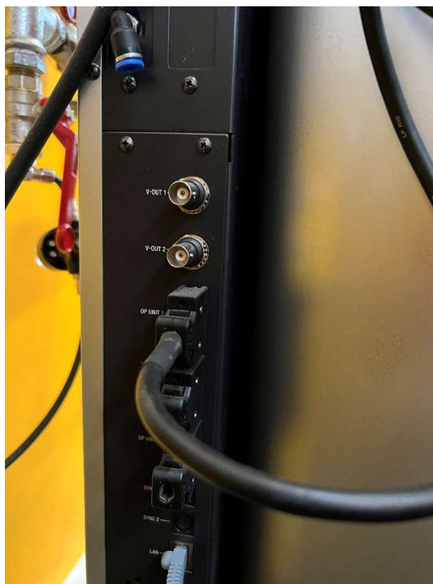
Obrázek zachycující dva konektory analogového výstupu signálu na stroji řady AGX-V.
