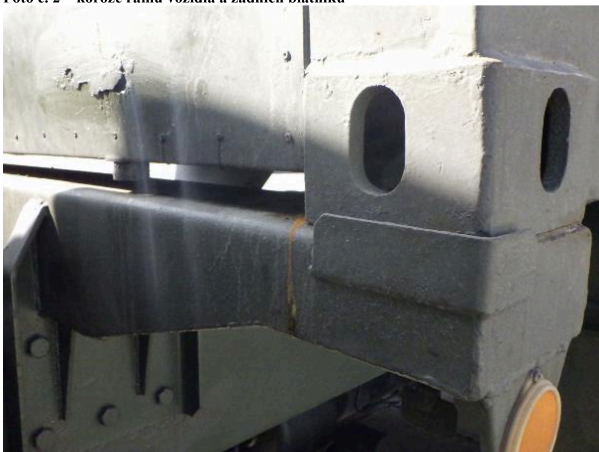
Foto č. 2 – koroze rámu vozidla a zadních blatníků
