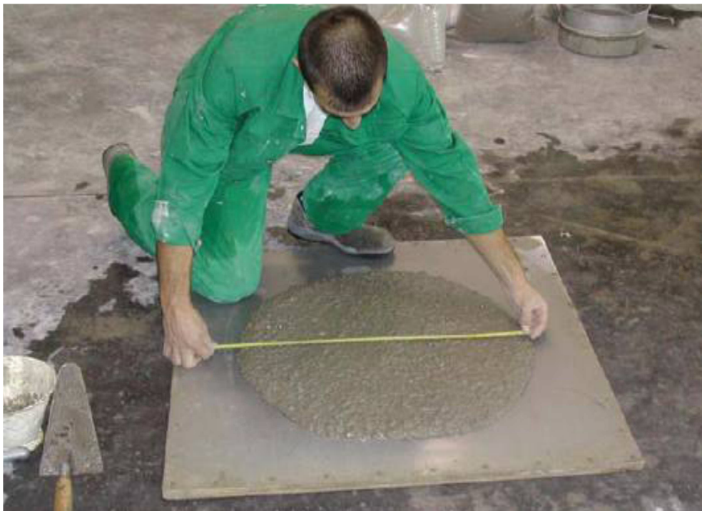
(3) Obr. 3 – Zkouška rozlití SCC - správně navržená směs
