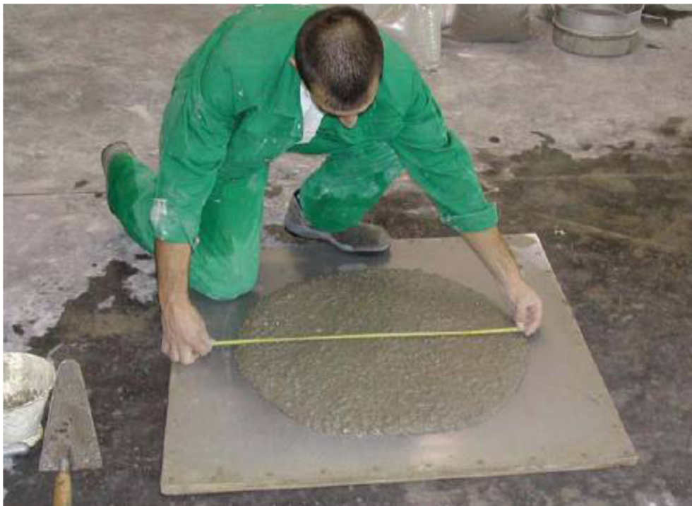
(3) Obr. 3 – Zkouška rozlití SCC - správně navržená směs
