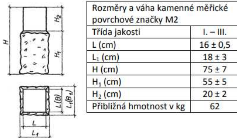
Obrázek 5 Rozměry povrchové kamenné značky M2
