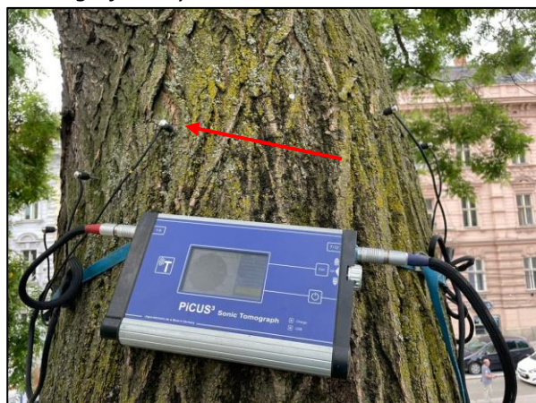
Tomografické vyšetření a instalované čidla:
